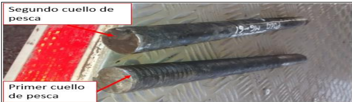
Figura 25. Distintos cuellos de pesca encontrados en el servicio a pozo #5.
