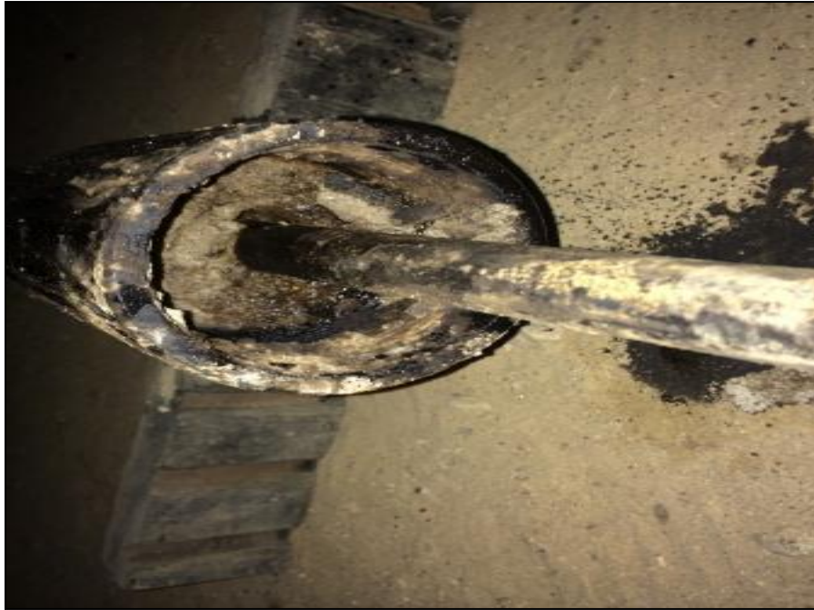
Figura 21. Sarta de producción del Pozo A llena y empaquetada con arena y scale y en el centro la varilla entrampada
