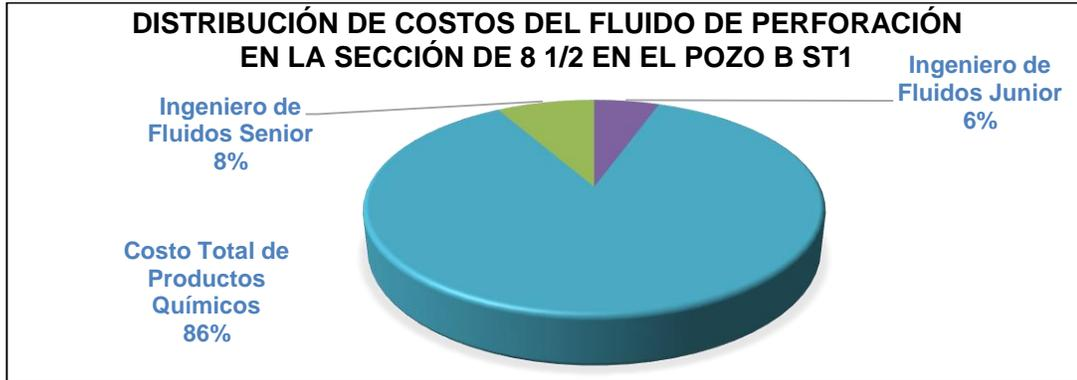
El Gráfico 20 representan la distribución costos del fluido de perforación en el Pozo B ST1 donde el 86% de los costos del fluido de perforación en la sección de 8½ corresponde a los productos químicos empleados. Como segundo porcentaje dentro de los costos en el fluido de perforación corresponde a la hora labor de los ingenieros de fluidos con un 14%. En el Gráfico 21 se representará la distribución de los costos de productos químicos por cada aditivo empleado en el Pozo B ST1.
