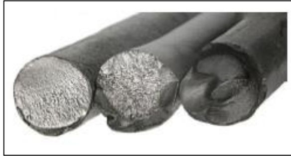
Figura 20. Daño en varillas por flexión.
