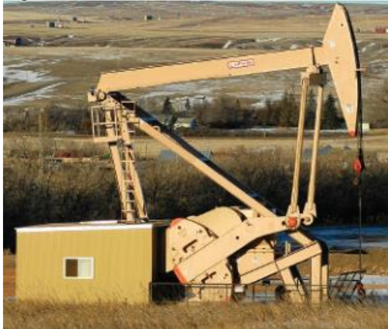
Figura 7. Unidad de bombeo mecánico Pozo BP2.
