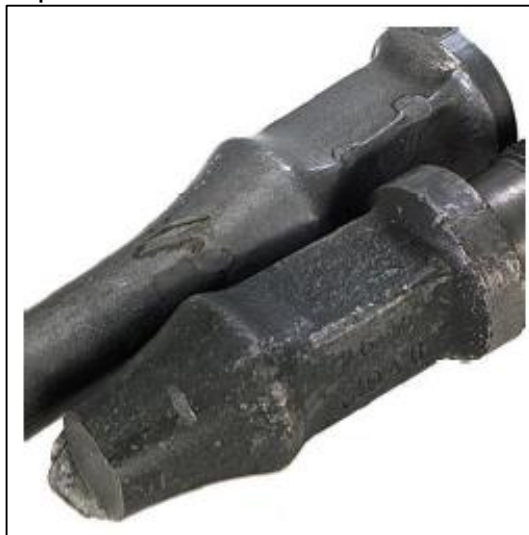
Figura 21. Daño en varillas por daños superficiales.
