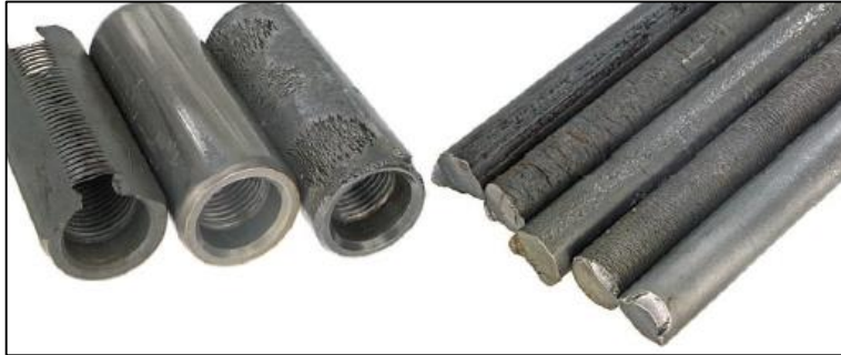
Figura 19. Daño en varillas por desgaste abrasivo.
