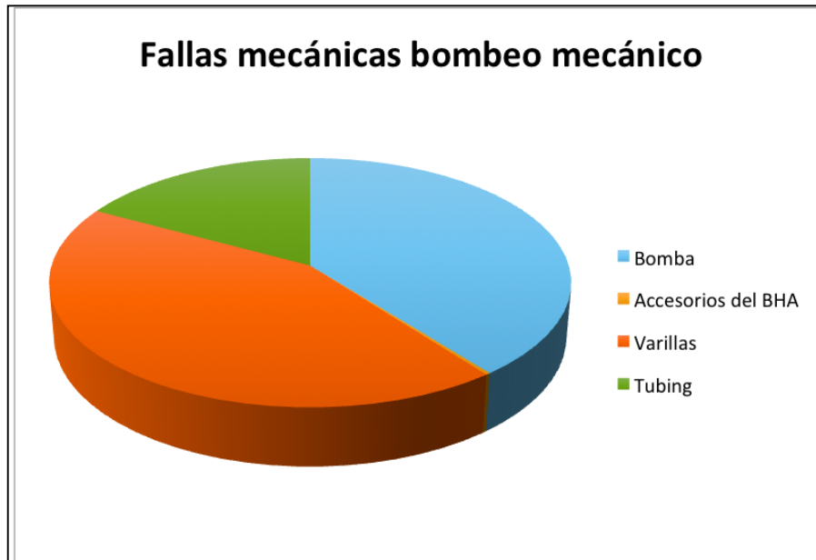
Gráfica 7. Fallas mecánicas bombeo mecánico en el Campo La Cira Infantas.
