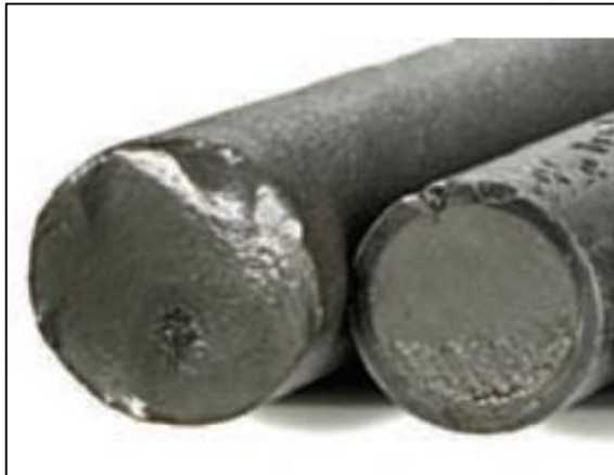
Figura 18. Daño en varillas por fatiga.
