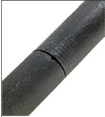
Figura 23. Daño en varillas por corrosión dada por CO 2 .
