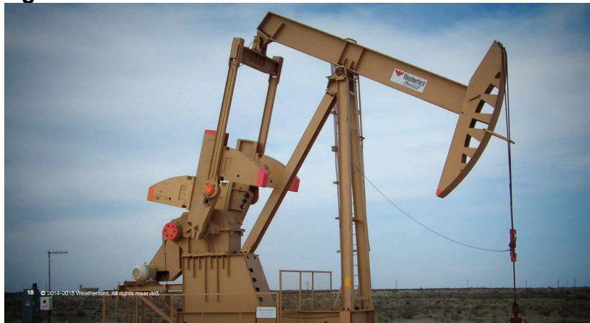
Figura 6. Unidad de bombeo mecánico Pozo BP1.
