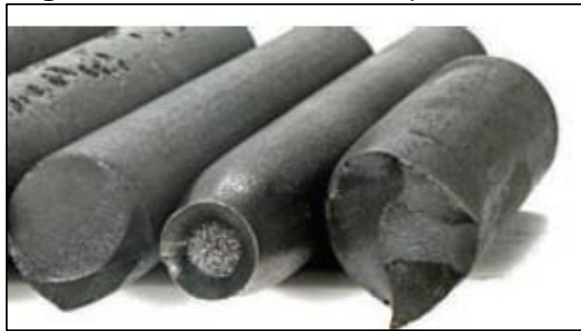
Figura 17. Daño en varillas por tensión.
