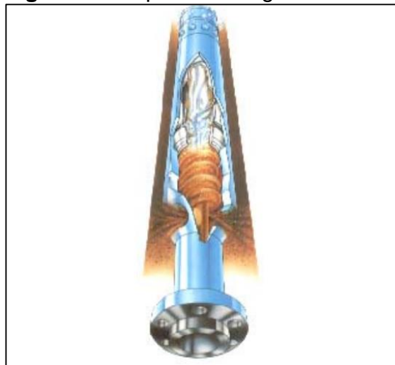
Figura 13. Separador de gas.
