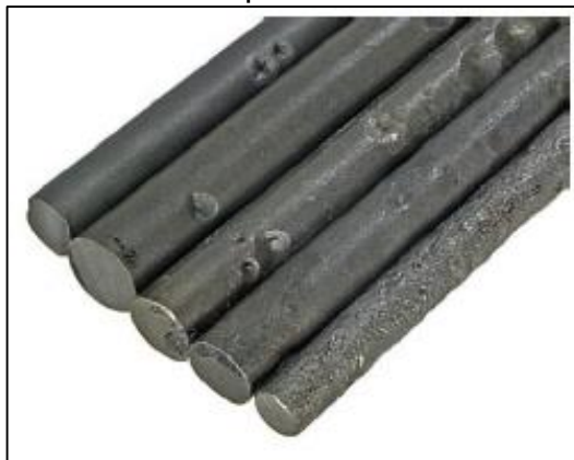
Figura 25. Daño en varillas por corrosión dada por H_2S .
