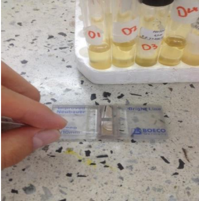
Figura 16. Procedimiento. (a) Toma de muestra; (b) Conteo en cámara de Neubauer para evaluar la curva de crecimiento; (c) lectura en microscopio.
