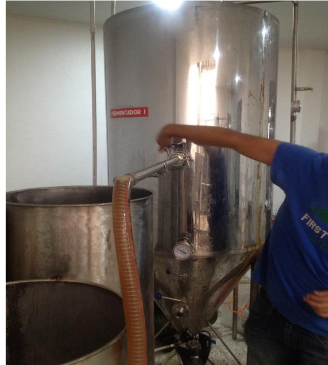
Figura 6. Fermentación del mosto. (a) Pre-enfriamiento del mosto; (b) Carga de mosto al fermentador
