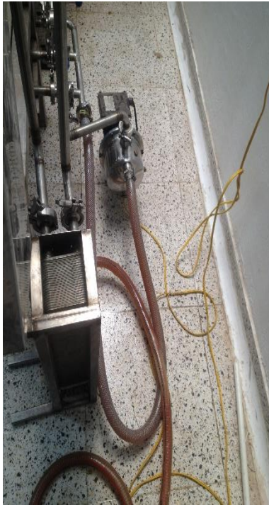
Figura 6. Fermentación del mosto. (a) Pre-enfriamiento del mosto; (b) Carga de mosto al fermentador
