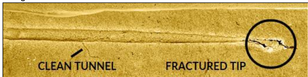
Figura 46. Perforado Generado por la Tecnología Reactive Liner Shaped Charges
