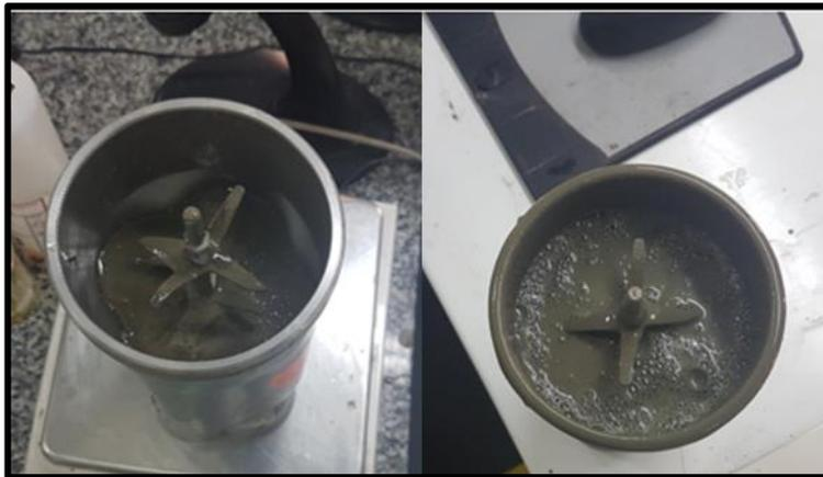
Como se observa en la **Figura 9**, el volumen de la lechada aumenta con la formación de la espuma, obteniendo así una lechada con una densidad de 12.49 lb/gal y una calidad de espuma aproximada del 13.3%, alcanzando un resultado muy cercano al esperado con la simulación de la lechada donde se había determinado una densidad de 12.5 lb/gal con una calidad de espuma del 15%.
