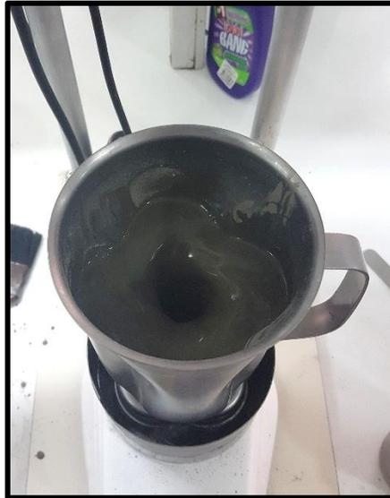
En la **Figura 19** se observa que el vórtice generado es de 5, según la escala mencionada en el capítulo anterior, este valor indica que la lechada de cemento a evaluar tiene la fluidez correcta y sus aditivos se diluyeron de forma correcta, dando como resultado una lechada homogénea.
