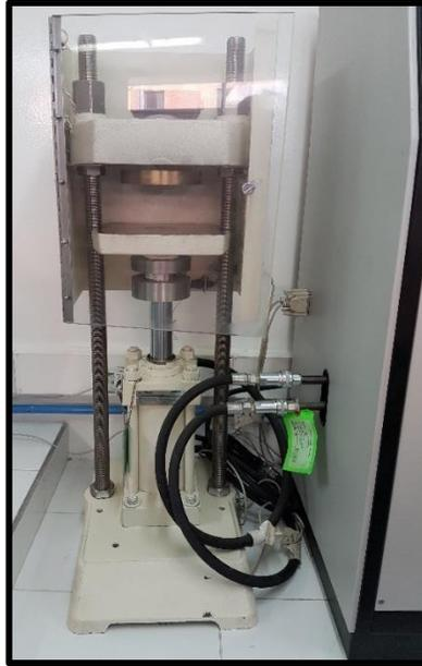
Como se observa en la **Figura 18**, la prensa hidráulica incrementará paulatinamente la presión hasta que la muestra de cemento seco se rompa, registrando la presión a la que el cemento se fractura.
