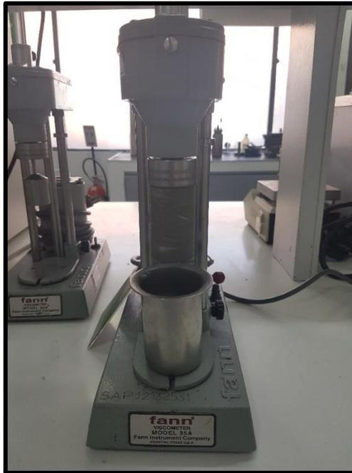
Como se puede observar en la **Figura 11**, el equipo posee un tambor giratorio en la parte superior y en la parte inferior tiene un recipiente en donde es agregado el fluido a evaluar. A lo largo de la prueba, se realizaron mediciones de forma ascendente y descendente para luego poder sacar un promedio de esfuerzos lo cual hace que el resultado sea más confiable.
