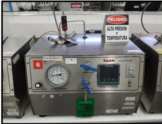
Como se puede observar en la **Figura 13**, en la parte superior se encuentra el recipiente en donde está el cemento, se observan los indicadores de presión y temperatura. La duración de la prueba fue de 48 horas en donde se recopiló la información de tiempo de tránsito y temperatura. En el **Gráfico 14** se observan los resultados de la prueba.
