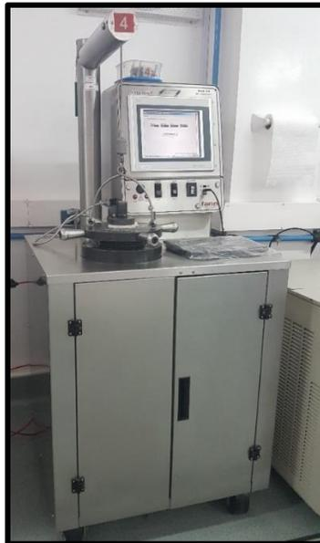
Como se puede observar en la **Figura 17** el equipo se programa a unas condiciones específicas y en el monitor se va observando el comportamiento del cemento a medida que va transcurriendo el tiempo de prueba. Además, el equipo en su interior cuenta con un aceite que se calienta con el fin de calentar la muestra del cemento.
