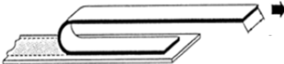
Ilustración 10. Prototipo de montaje de la Prueba de "Pelado".
