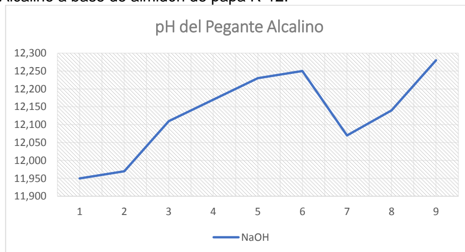
Gráfica 6. Resultados de pH de la caracterización de un Pegante Alcalino a base de almidón de papa R-12.
