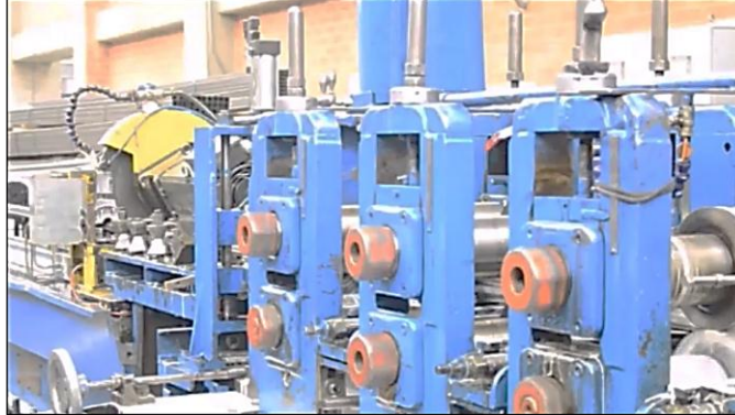
Figura 6. Moldeo de lámina de acero a tubo.
