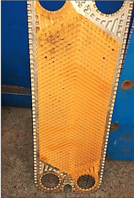
Figura 15. Placa de intercambiador de calor, lado corroído.
