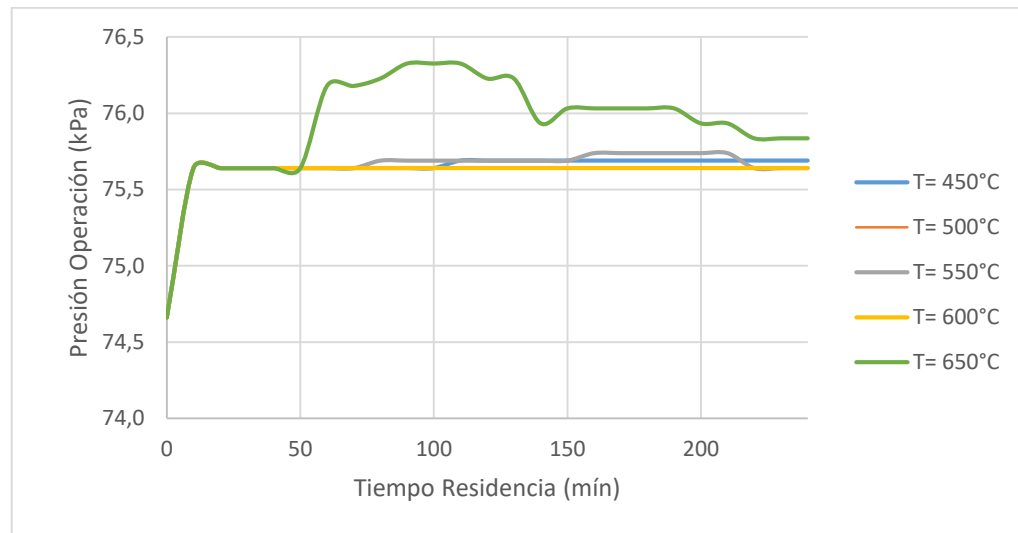
Gráfica 22. Comportamiento de la Presión de Operación del sistema en función del Tiempo a diferentes Temperaturas.
