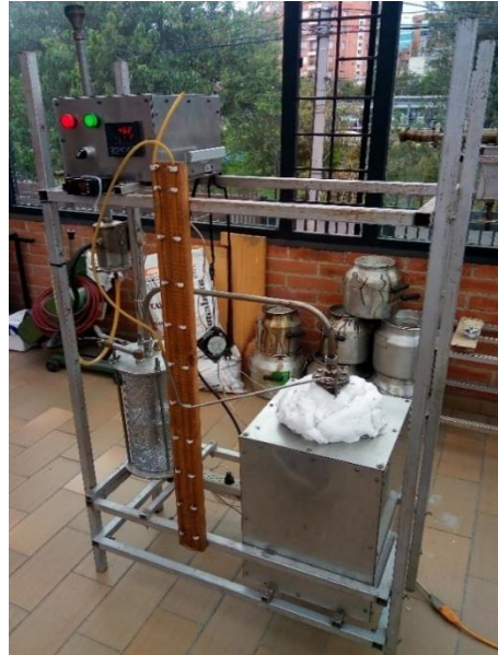
Figura 19. Montaje a Nivel de Laboratorio empleado para la pirólisis de GCR.
