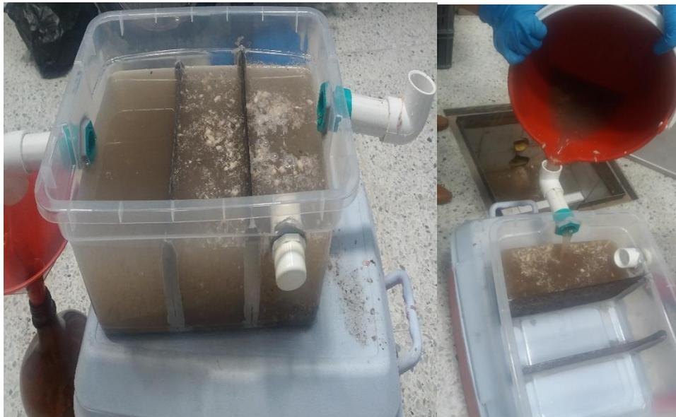
Como la elaboración de la trampa de grasa en la empresa es una modificación a la existente, los materiales propuestos son de obra, cemento gris, cemento blanco, baldosa para todo el volumen incluyendo los compartimientos, tubos y codos para las entradas y salidas propuestas en el diseño.
