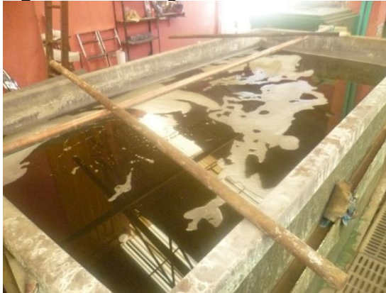
Figura 9. Desengrase en caliente
