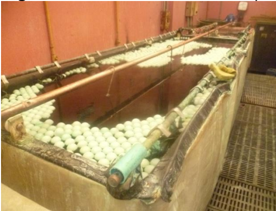
Figura 11. Baño electrolítico de níquel
