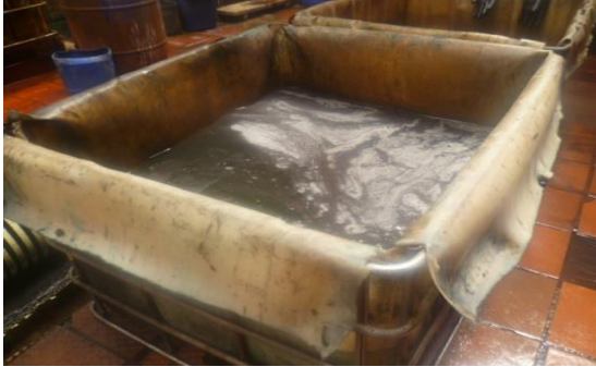
Figura 6. Tanque de decapado
