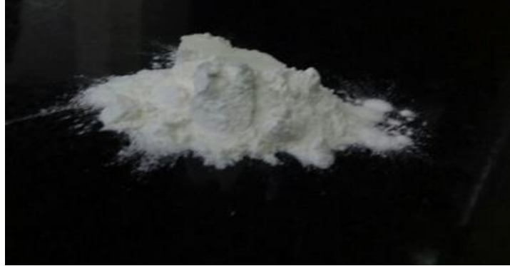
Figura 19. Microcristales de celulosa (45-105 \mu\text{m} ).
