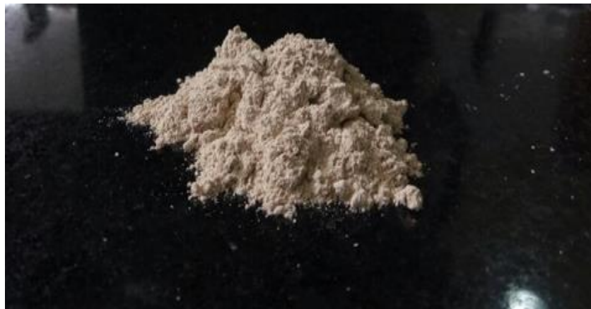
Figura 18. Polvo de cascarilla de arroz (105-149 \mu\text{m} ).
