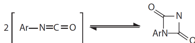
Figura 8. Estructura reacción con isocianatos aromáticos.
