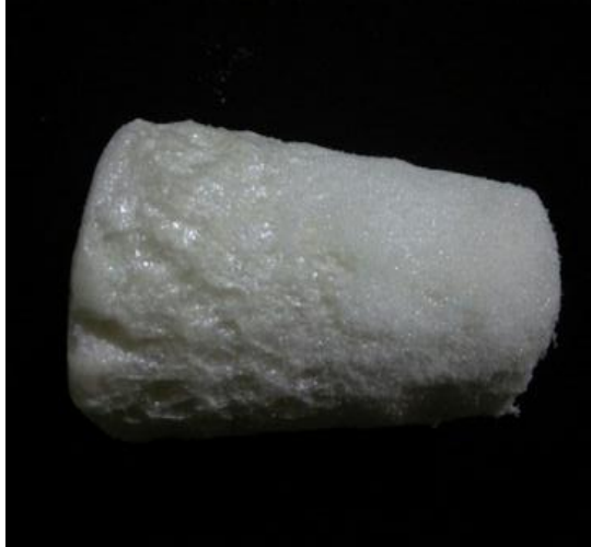
Figura 21. Celdas irregulares del ensayo número 6.
