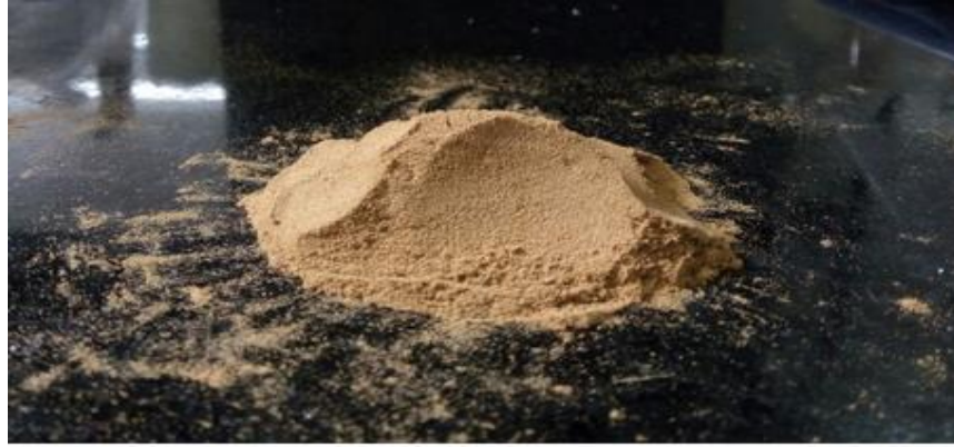
Figura 17. Polvo de cáscara de mango (105-125 \mu\text{m} ).
