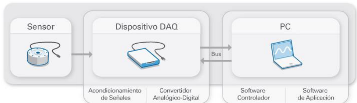
Figura 2. Esquema de las partes de un sistema de adquisición de datos
