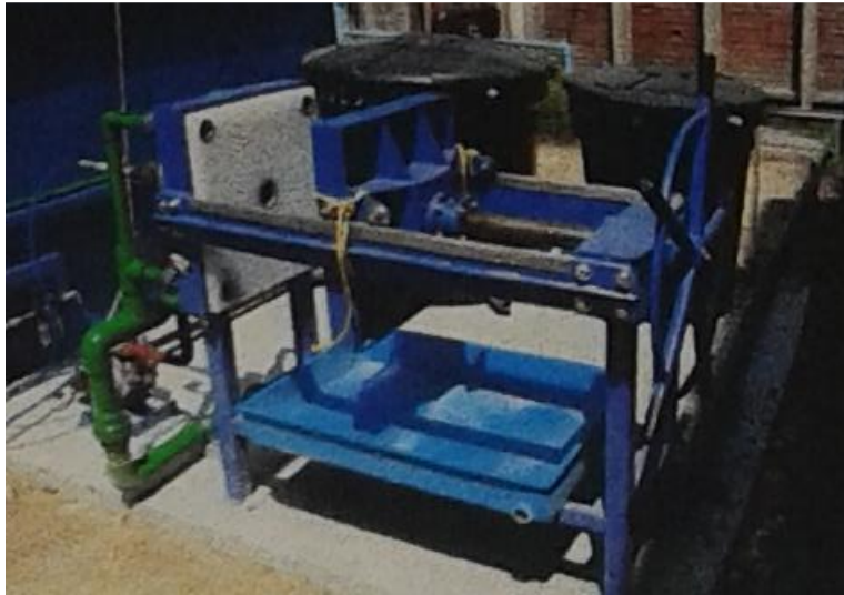
Figura 24. Filtro prensa modelo KKA-470-6AC-CMAN.
