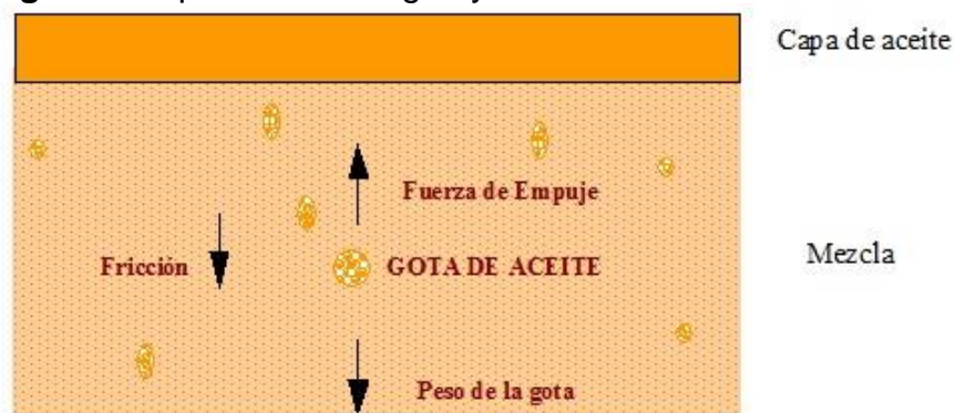
Figura 4. Separación del agua y el aceite debido a la densidad
