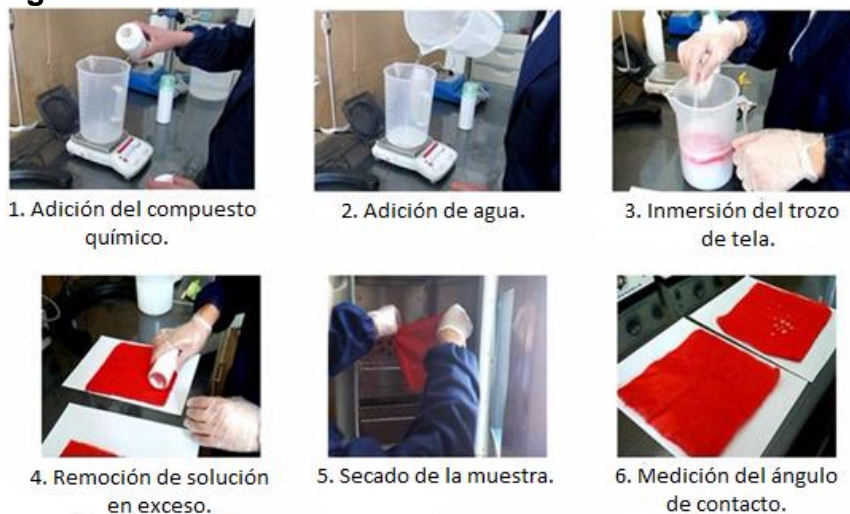
Figura 10. Procedimiento de inmersión en solución.
