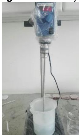
Figura 21. Montaje prueba de resistencia al lavado.
