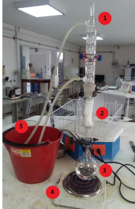
Figura 11. Montaje de la extracción por método Soxhlet
