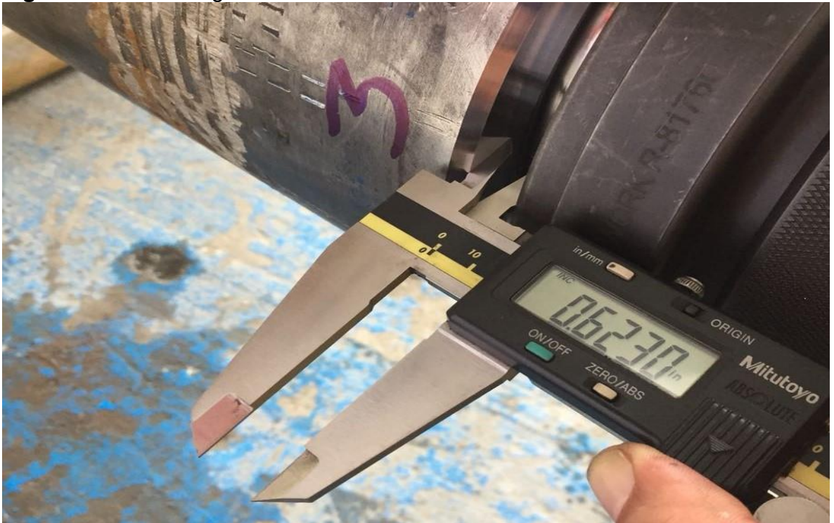
Figura 33. Tercer ángulo de medición a la conexión antes del tratamiento
