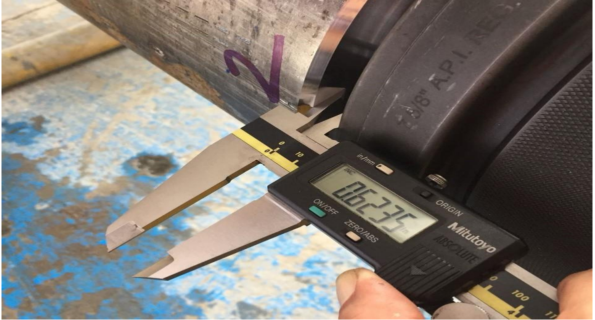
Figura 32. Segundo ángulo de medición a la conexión antes del tratamiento
