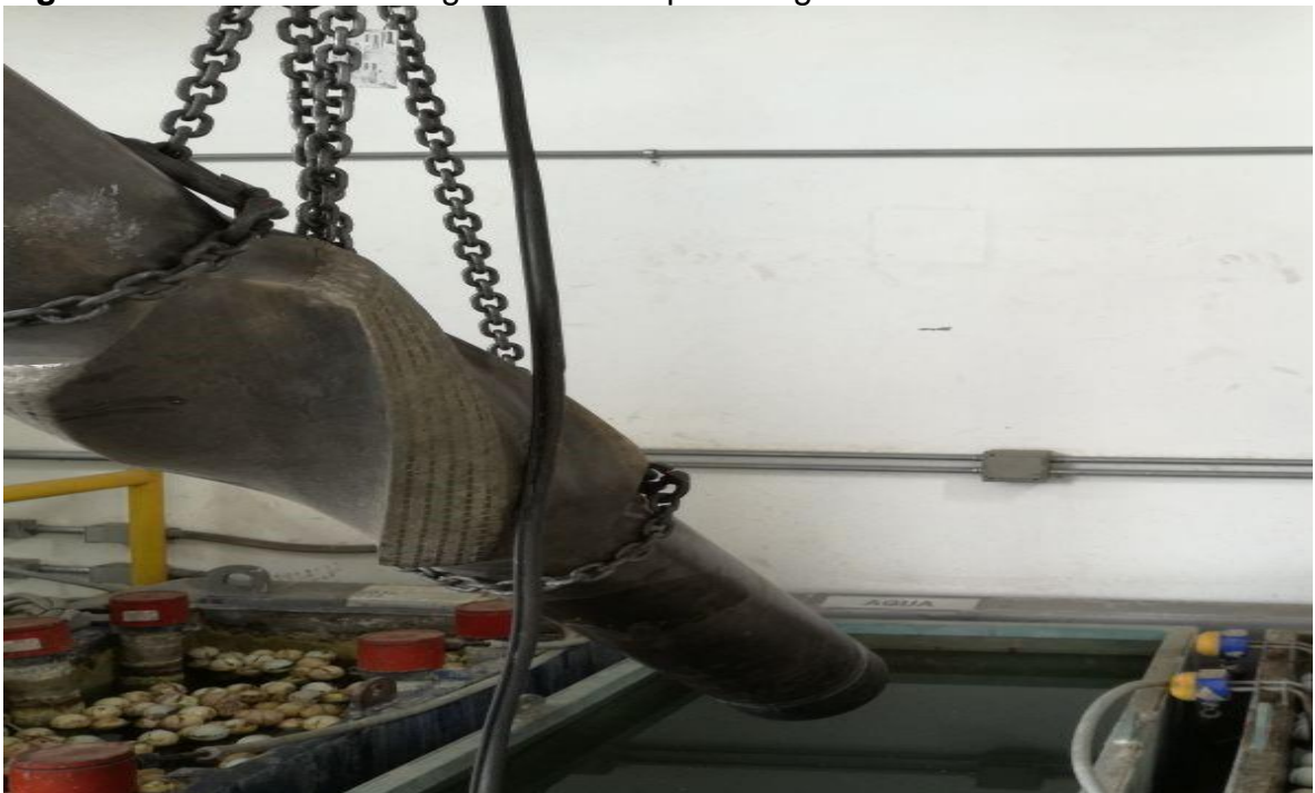
Figura 27. Conexión sumergida en el tanque de agua.
