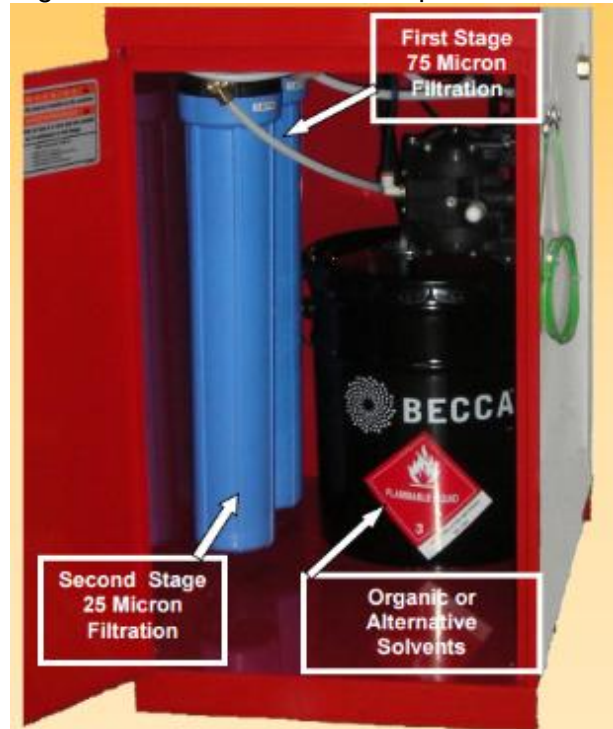
Figura 6. Proceso de reciclado por filtración.
