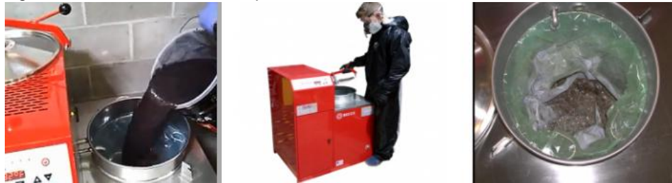
Figura 5. Proceso de reciclado por destilación.
