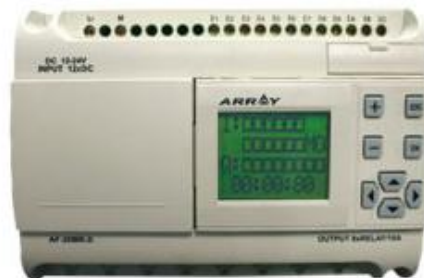
Figura 42. PLC Array seleccionado
