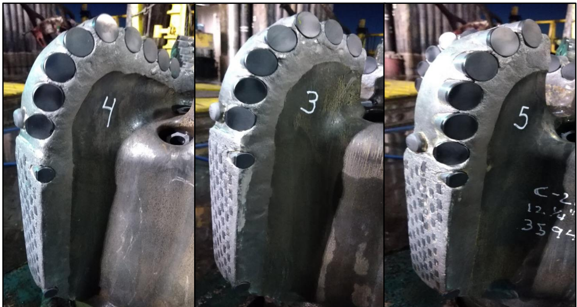
Figura 56. Sección B del estado final de la broca tras la primera corrida en el pozo C216
