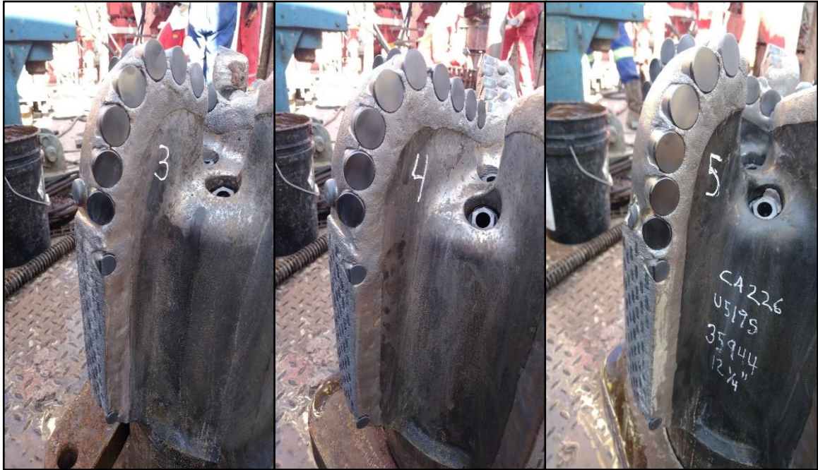
Figura 64. Sección B del estado final de la broca tras la primera corrida en el pozo C226
