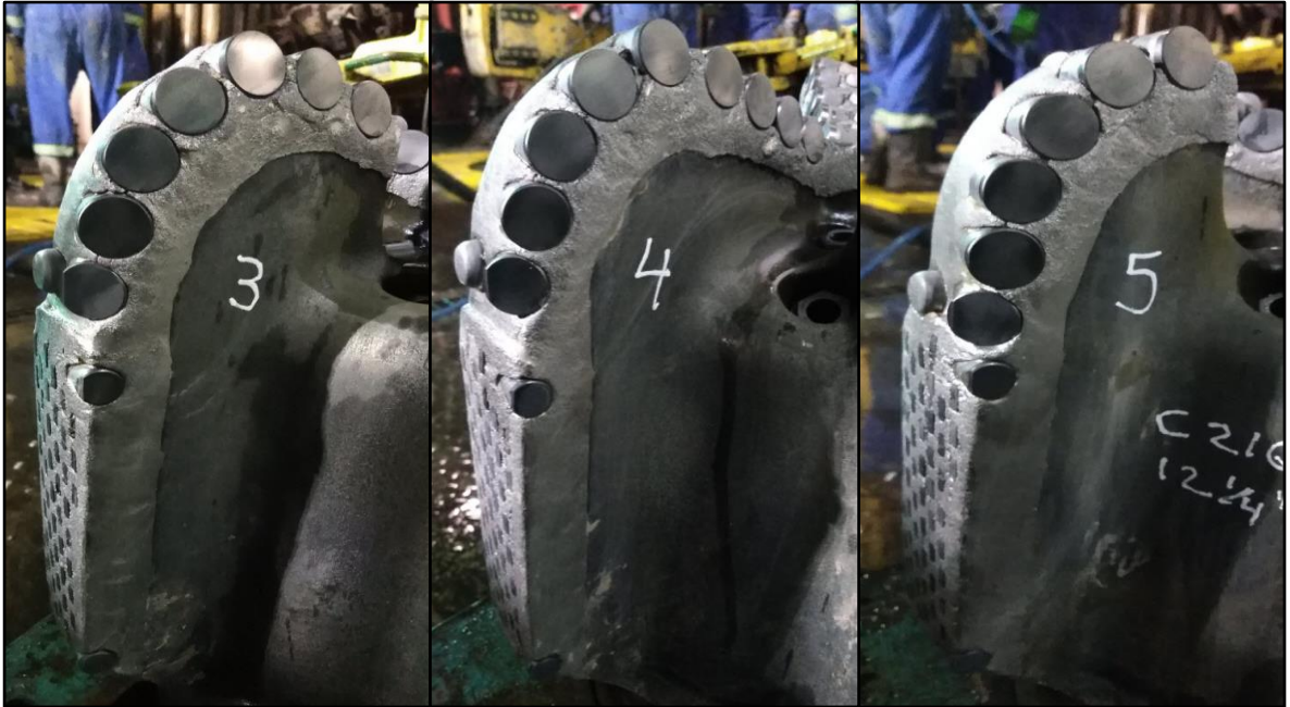
Figura 58. Sección B del estado final de la broca tras la segunda corrida en el pozo C216
