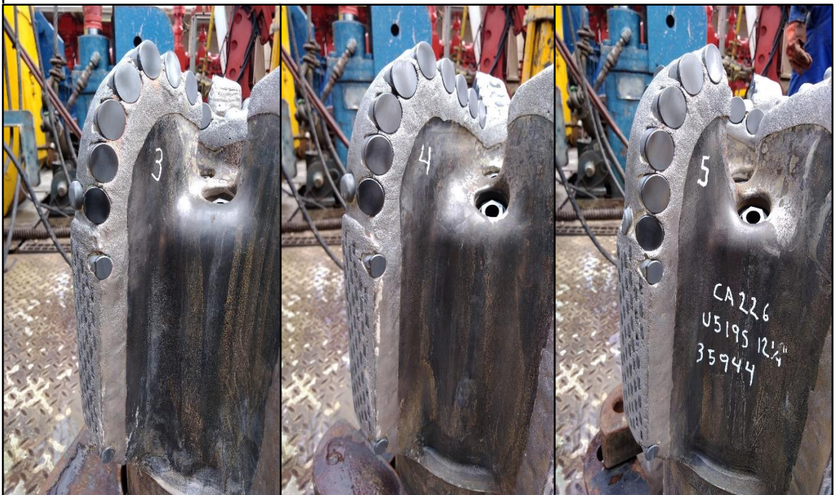
Figura 66. Sección B del estado final de la broca tras la segunda corrida en el pozo C226
