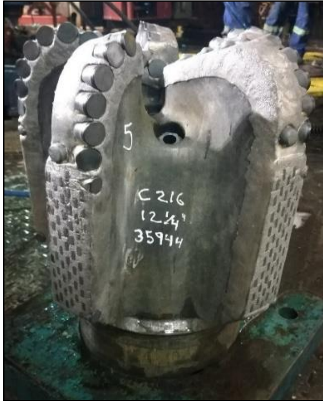
Figura 38. Vista del calibre de la broca con calibre de 6"- Castilla 216
