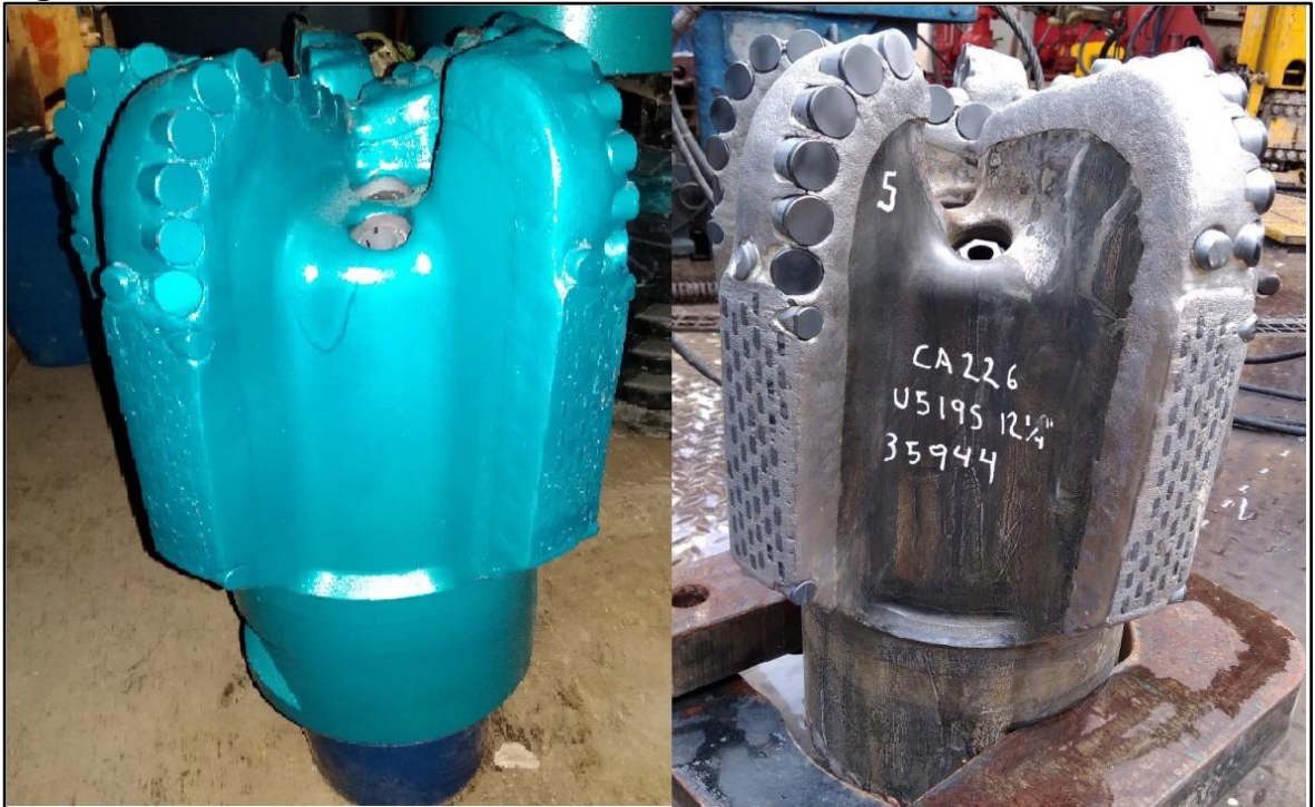
Figura 45. Vista del calibre de la broca con calibre de 6"- Castilla 226
