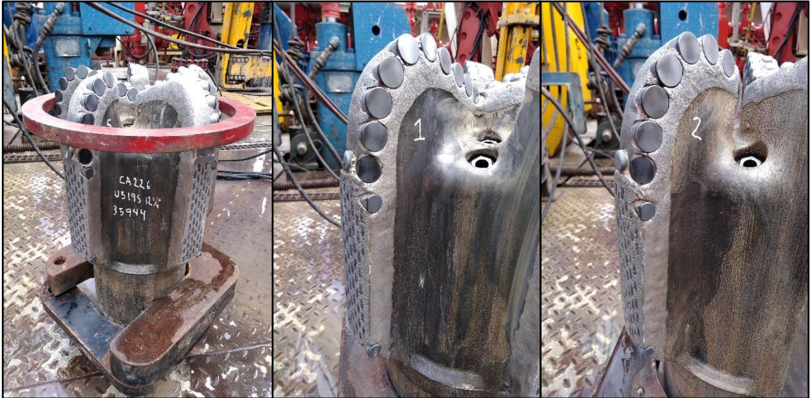
Figura 65. Sección A del estado final de la broca tras la segunda corrida en el pozo C226
