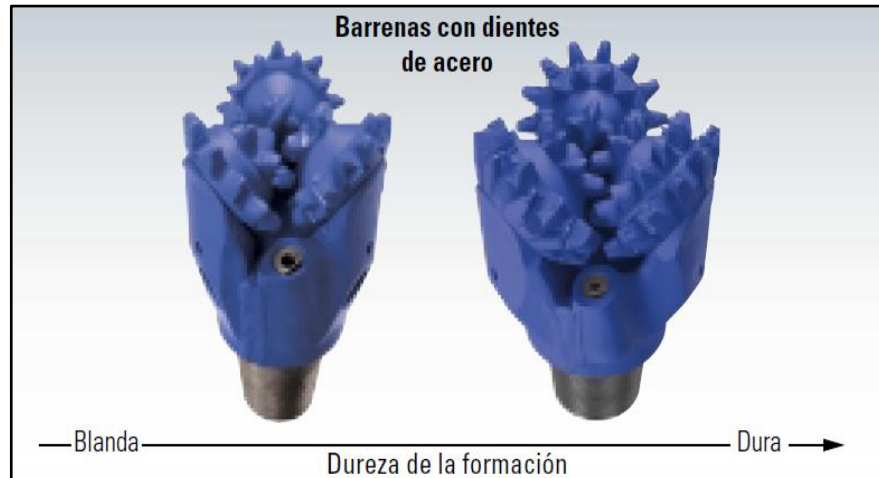
Figura 5. Relación de los dientes de las brocas triconicas con la dureza de la formación.
