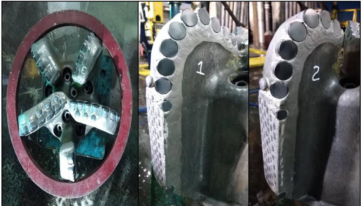
Figura 55. Sección A del estado final de la broca tras la primera corrida en el pozo C216
