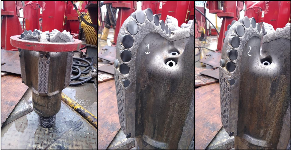
Figura 71. Sección A del estado final de la broca tras la primera corrida en el pozo CN281
