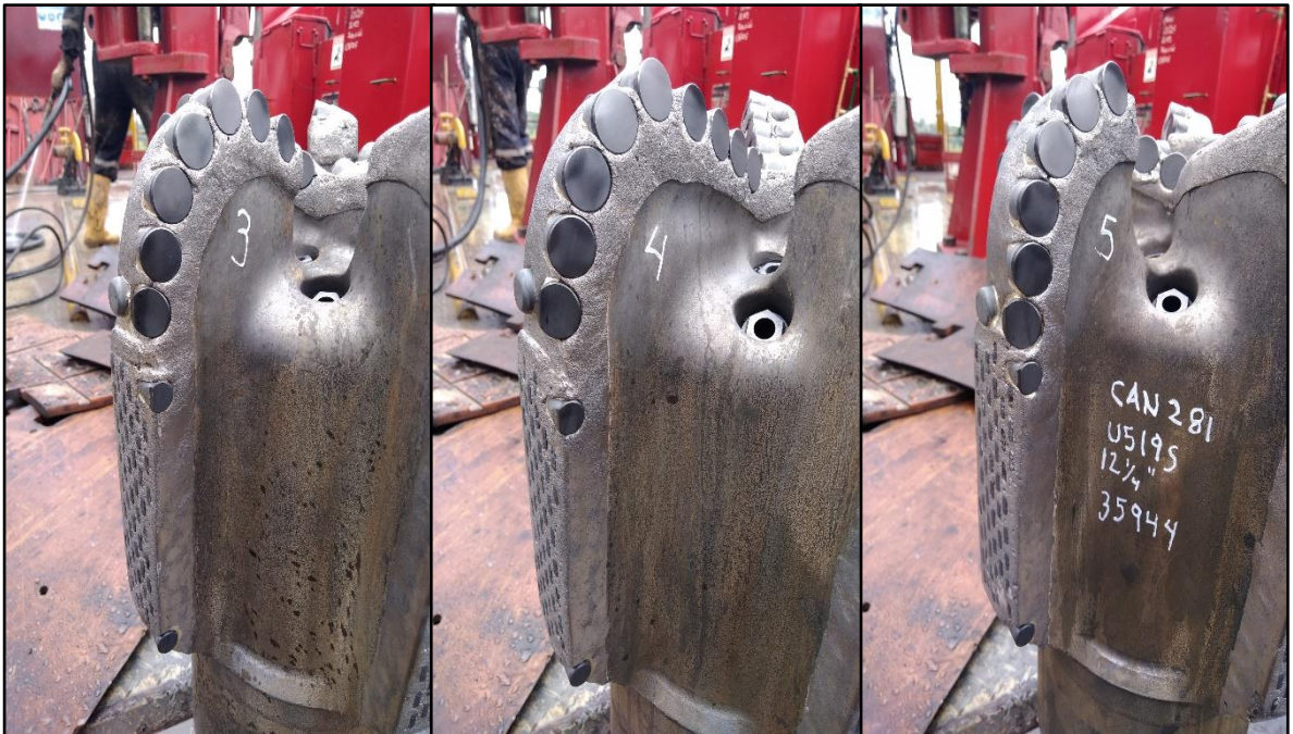
Figura 72. Sección B del estado final de la broca tras la primera corrida en el pozo CN281
