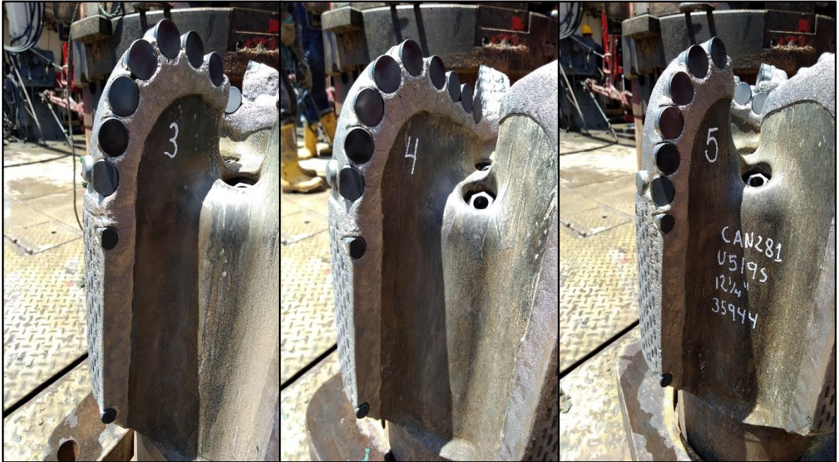
Figura 74. Sección B del estado final de la broca tras la segunda corrida en el pozo CN281
