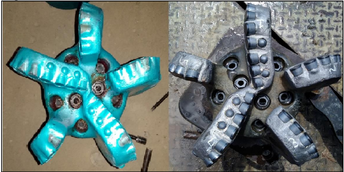
Figura 51. Vista de Planta de la broca con calibre de 6"- Castilla Norte 281
