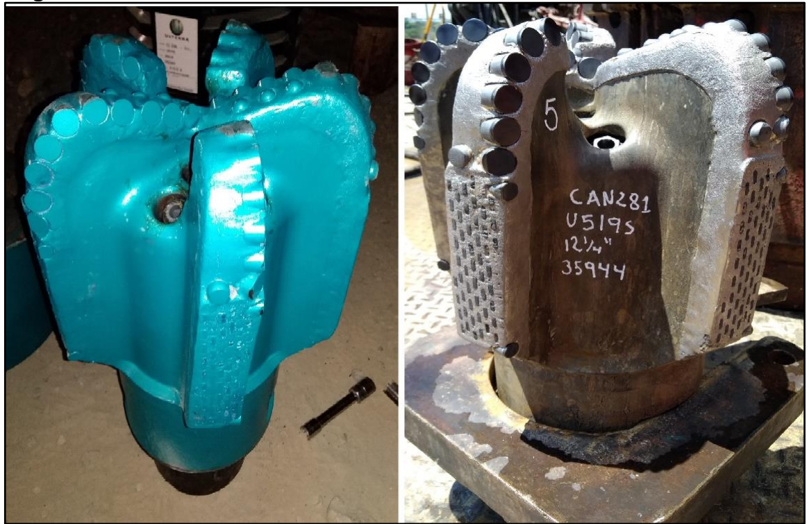
Figura 52. Vista del calibre de la broca con calibre de 6"- Castilla Norte 281
