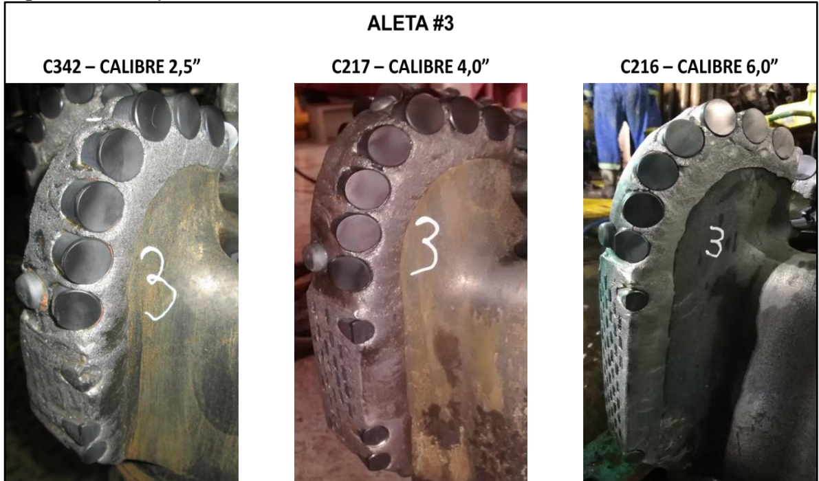
Figura 79. Comparación de la aleta #3 con los distintos calibres
