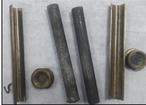
En la **Figura 47** se puede observar el procedimiento basado en la norma API RP 10B para la realización de la prueba de sedimentación.
