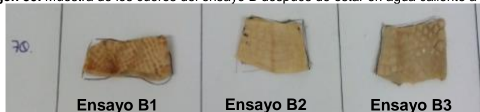
Imagen 39. Muestra de los cueros del ensayo B después de estar en agua caliente a 70°C.
