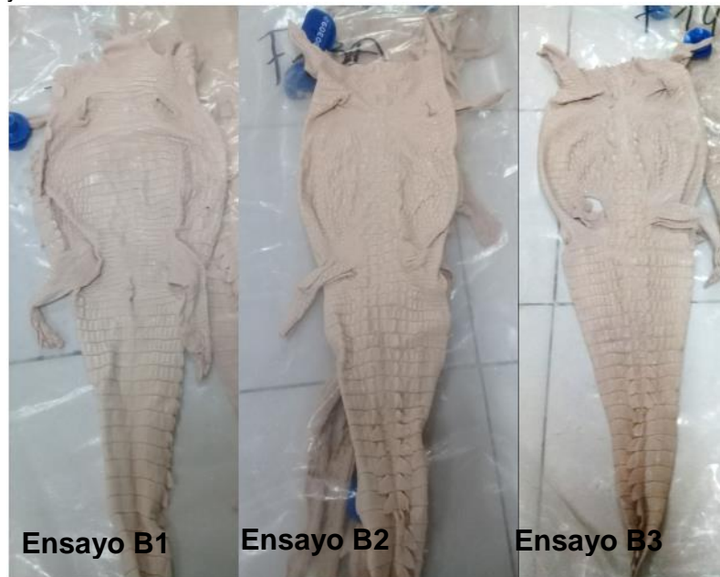
Imagen 32. Pieles después del curtido mixto de los ensayos B1, B2 y B3.
