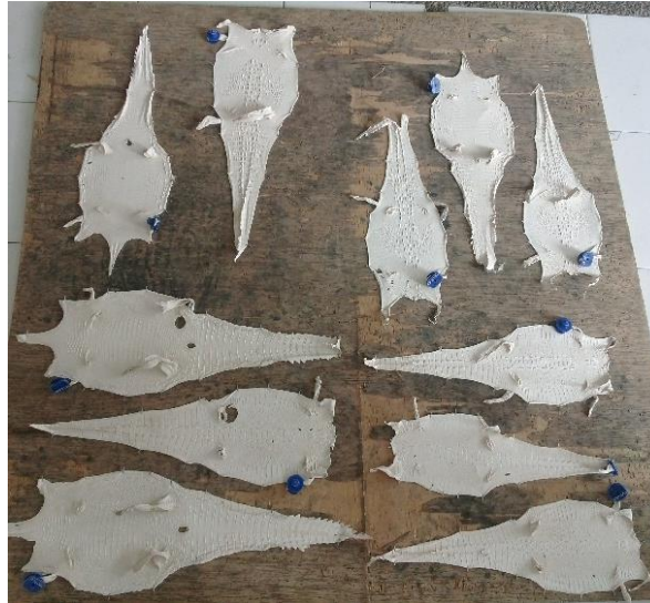
Imagen 34. Pieles de los ensayos A y B en la etapa de tablado.
