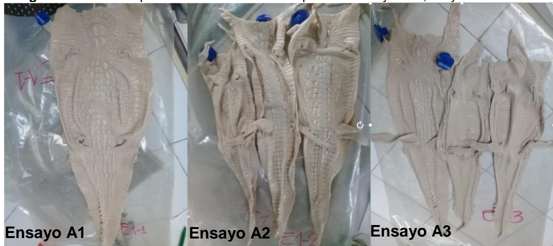
Imagen 31. Pieles después del curtido aldehídico para los ensayos A1, A2 y A3
