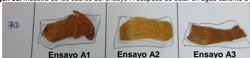
Imagen 38. Muestra de los cueros del ensayo A después de estar en agua caliente a 70°C.
