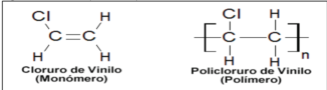
Figura 1. Estructura química del policloruro de vinilo.
