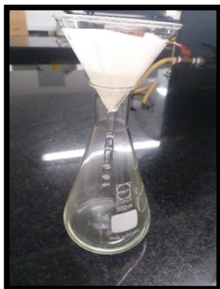
Ilustración 15. Filtración con embudo para el desinfectante blanqueador.
