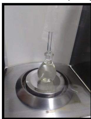
Ilustración 14. Picnómetro con desinfectante para prueba de densidad de líquido.
