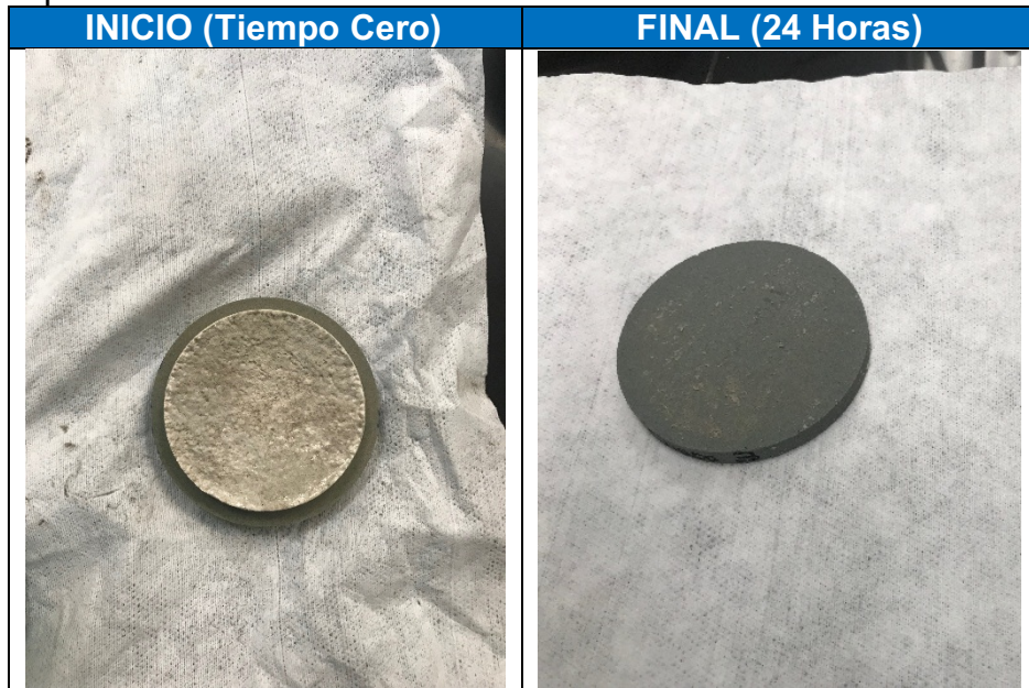
Imagen 28. Antes y después de la remoción de cake por remojo a presión
