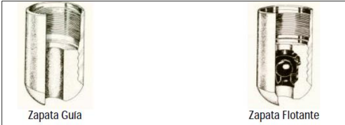
Figura 18. Zapata guía y zapata flotante
