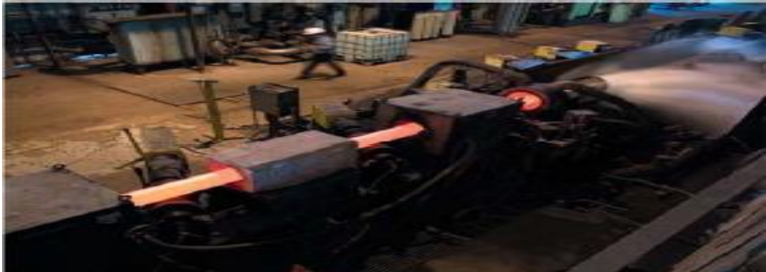
Figura 4. Fabricación de la tubería de Revestimiento
