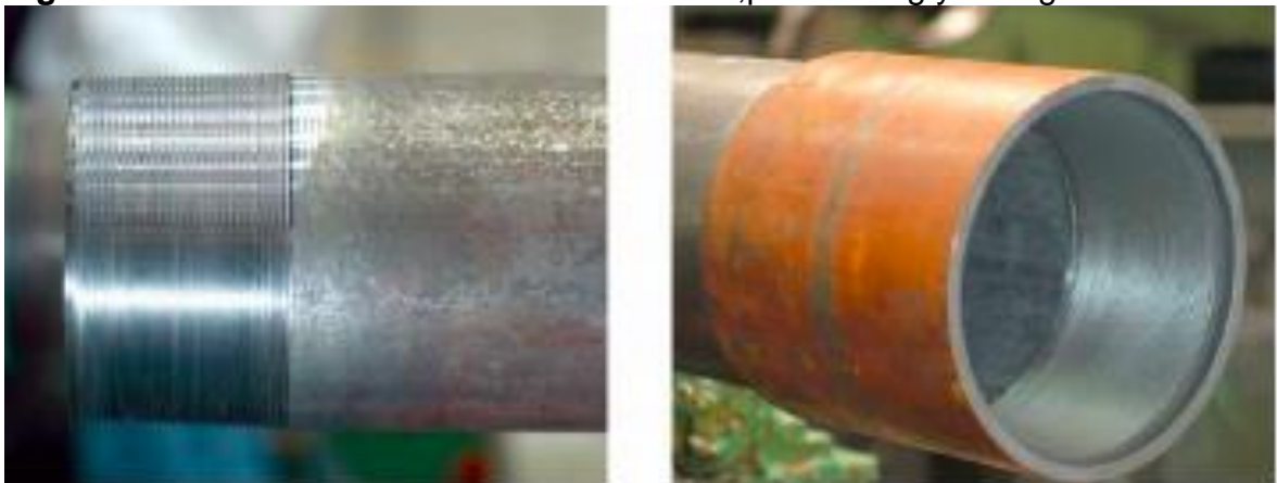
Figura 5. Pin and Box de 8 hilos rosca redonda, para casing y tubing
