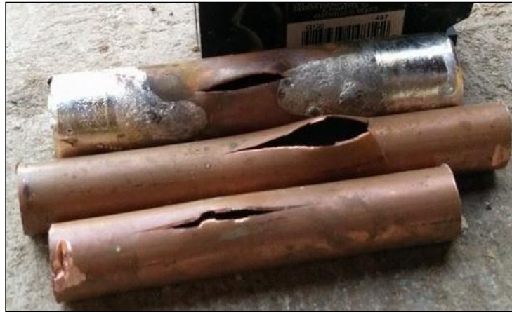
Imagen 26: Tubería después de la prueba de estallido
