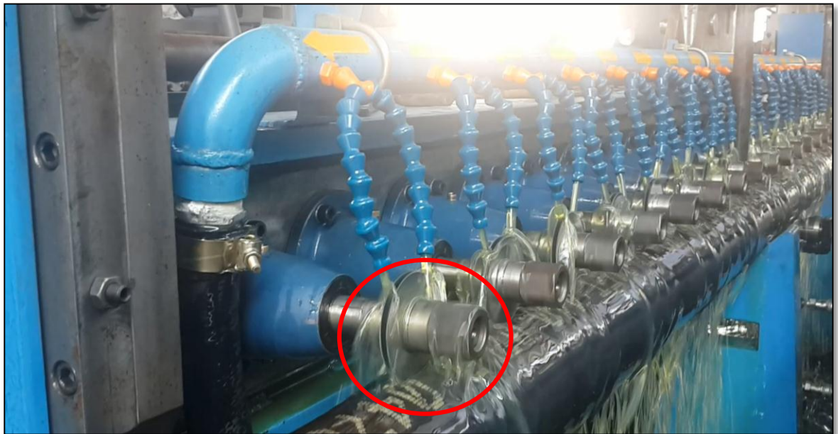
Imagen 22: Ranurado de tubería
