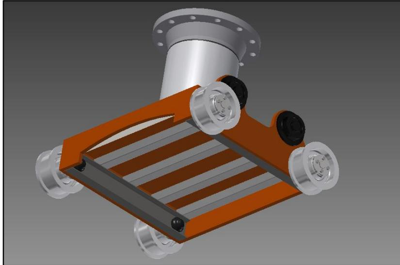
Para iniciar el proceso de ensamblaje de este sistema de rodadura se debe empezar con la estructura la cual está compuesta por dos perfiles en I y cinco vigas transversales de perfil cuadrado las cuales estarán soldadas en dos puntos; uno se fijará encima de los perfiles en I, y dos se soldarán a las láminas laterales.
