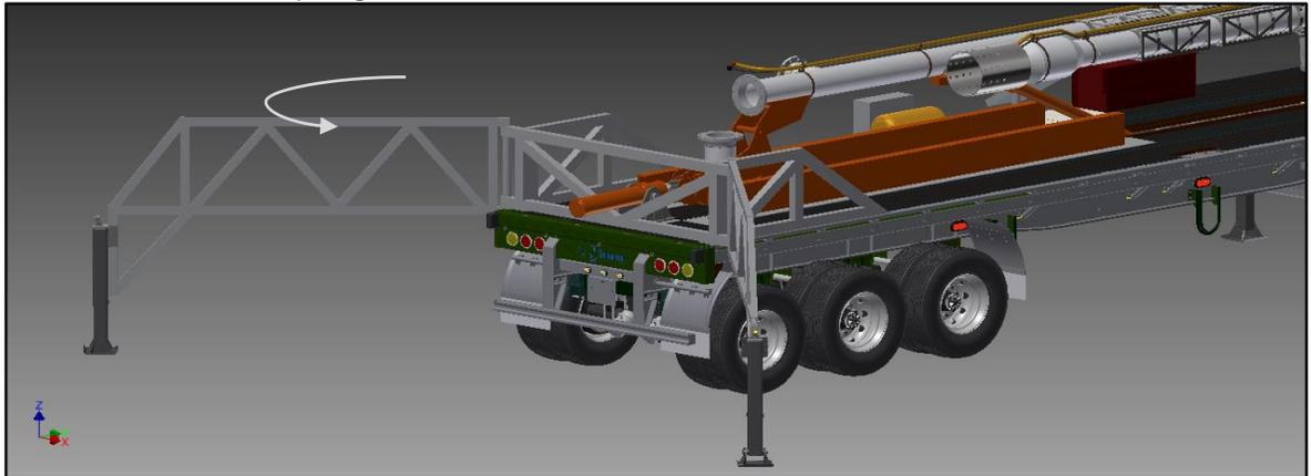
4.2.3 Puntos de movimiento de la Tea. Al expandir manualmente la Tea haciendo rotar sobre la unión de bisagra la sección de 8 metros y se ajusta con los 12 pernos de las bridas a la sección de 10 metros, a partir de ese momento la tea estará totalmente extendida y asegurada, esta estará sostenida por los apoyos que serán los puntos más importantes que permitirán el movimiento y levantamiento de la Tea.
