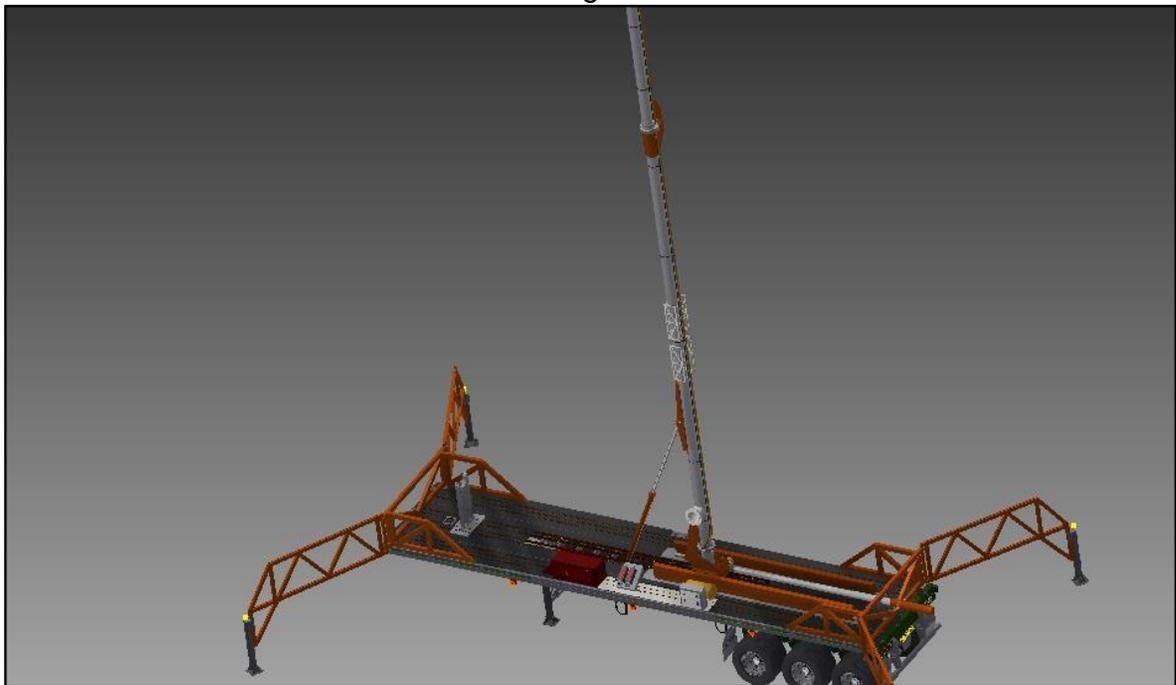
Cuando el cilindro telescópico se despliega obliga a la Tea a inclinarse más hasta quedar totalmente levantada. Cuando se logra el acople de la tea con la sección bridada en el sistema de deslizamiento se deben ajustar los 12 pernos que están dispuestos. El paso que se debe seguir es tomar las riendas que están
