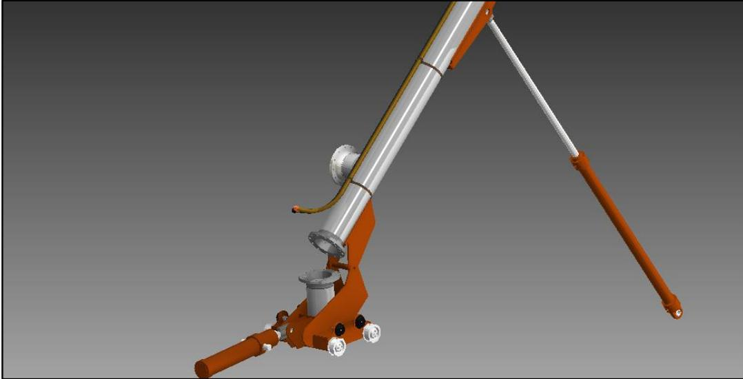
El sistema hidráulico del diseño de la Tea tiene como función el levantamiento y desplazamiento del ducto de la antorcha que conduce el gas para incinerarlo, para realizar esta labor se ha descrito anteriormente que para el levantamiento del tubo, se dispondrá de un cilindro hidráulico de doble efecto y para el desplazamiento del tubo a través de la plataforma del tráiler debido a la poca disponibilidad de espacio se dispondrá de un cilindro hidráulico telescópico de doble efecto.
