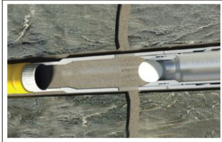
Figura 46. Camisa de fractura activada por bola en la posición abierta.
