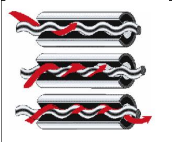
Figura 9. Estator y rotor metálico
