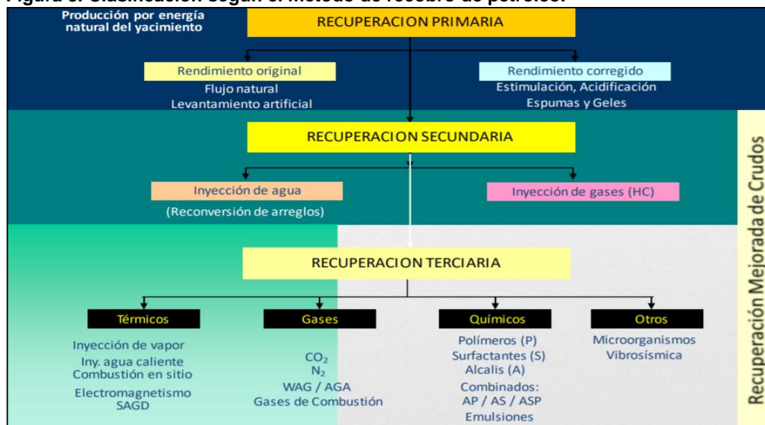
Figura 8. Clasificación según el método de recobro de petróleo.
