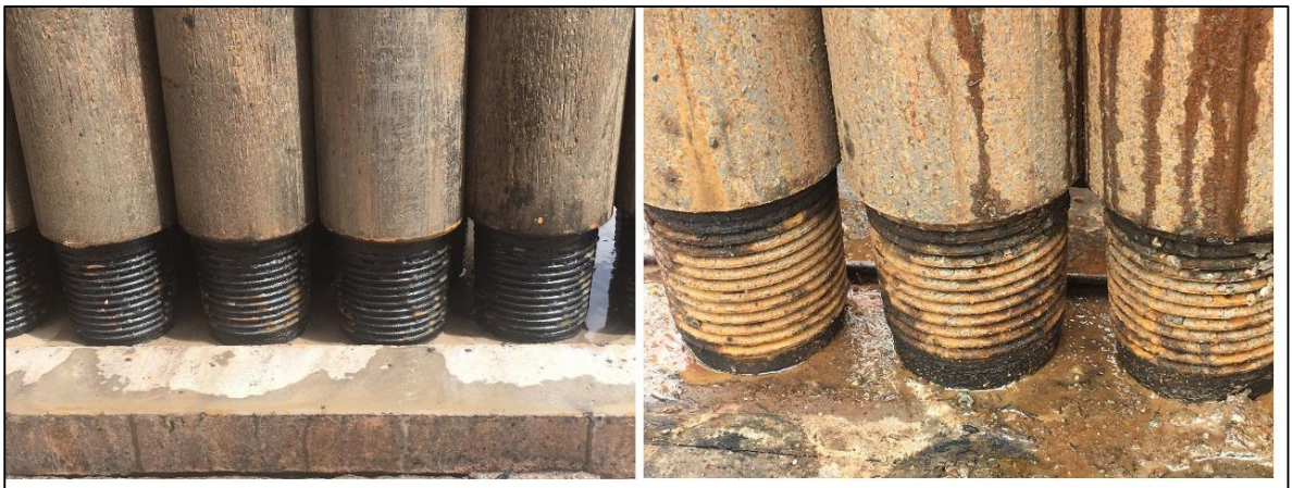
Figura 23. Afectaciones ambientales en la tubería
