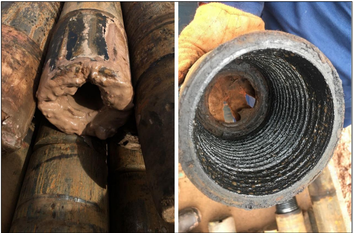
Figura 27. Residuos de la tubería en los Campos estudiados
