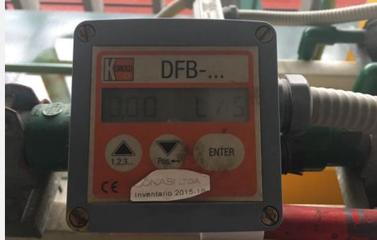
**Figura 5.** Pantalla de medidor de caudal ubicada en el piso superior de la planta piloto.
