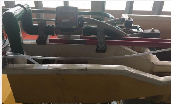
**Figura 15.** Dosificación de coagulante y alcalinizante en la planta piloto.
