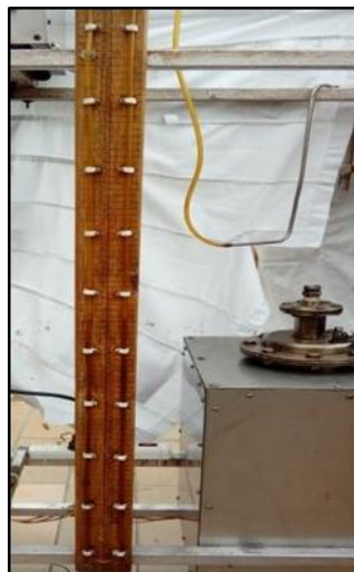
Imagen 10. Manómetro tipo U.
