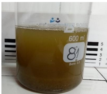
Figura 9. Prueba de apariencia en combustibles. CALIFICACIÓN NO PASA
