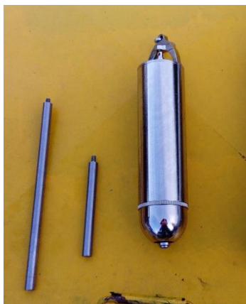
Figura 7. Tomador de muestras Bomba Bacon
