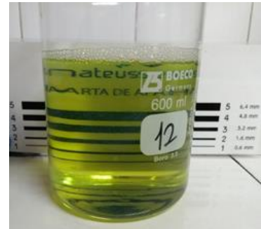
Figura 11. Prueba de apariencia en combustibles CALIFICACIÓN 1
