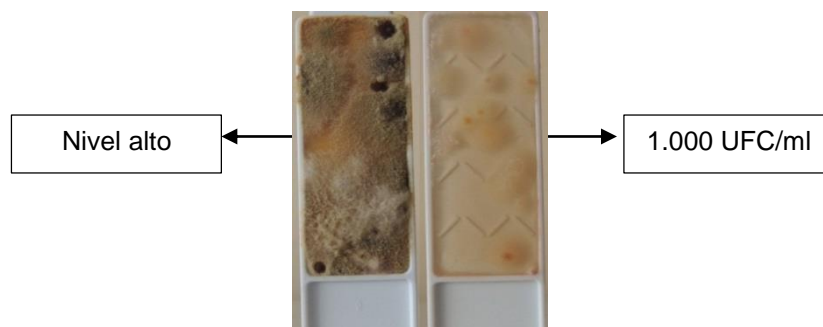
Figura 22 Prueba microbiológica para la EDS seleccionada Izquierda: prueba para moho y levadura. Derecha: prueba para bacterias.
