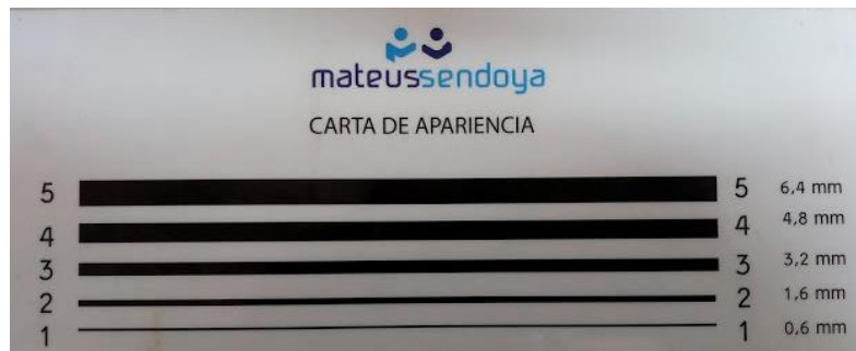
Figura 8. Carta de apariencia, según ASTM D4176
