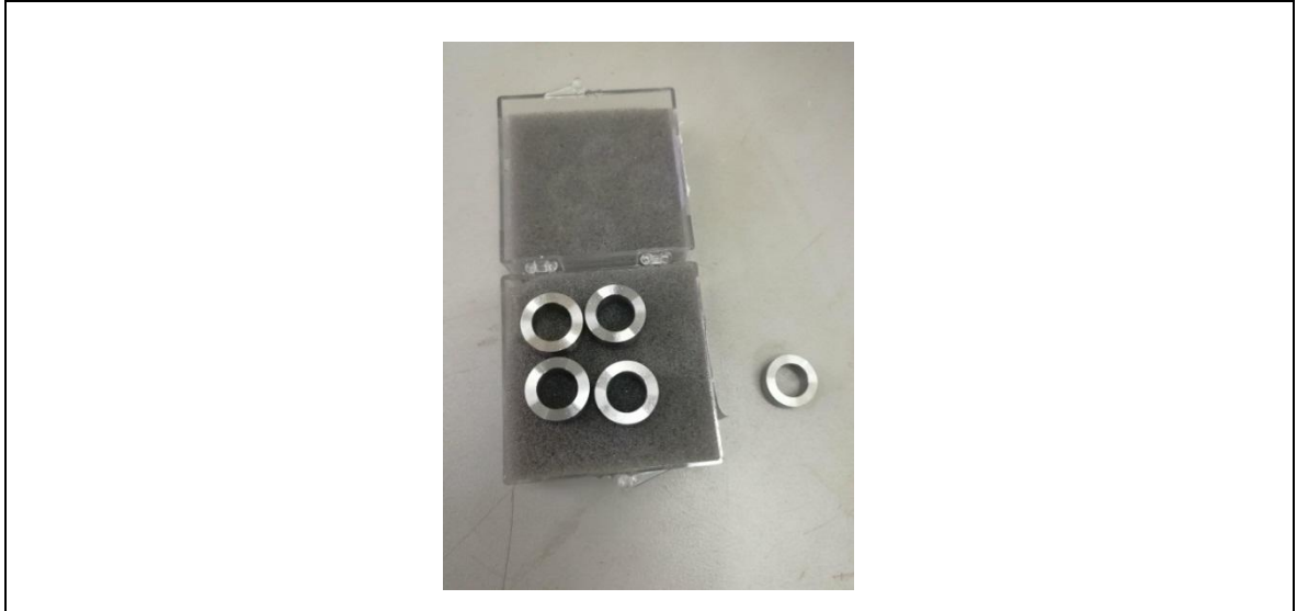
Imagen 4. Cupones de corrosión acero al carbón 1020.
