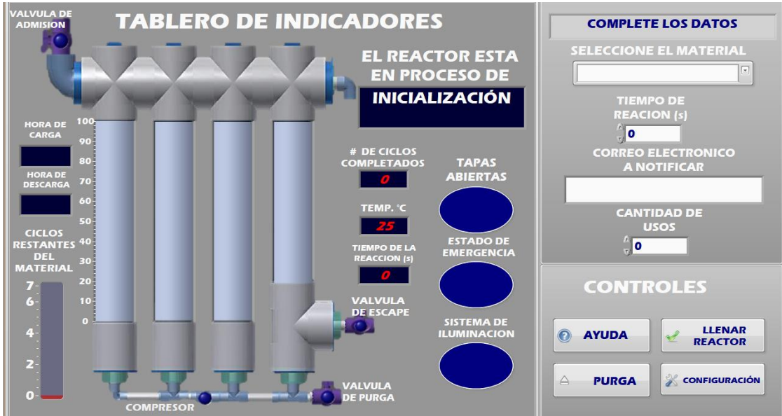
Ilustración 16. Panel frontal: estado de inicialización. LabVIEW 2016
