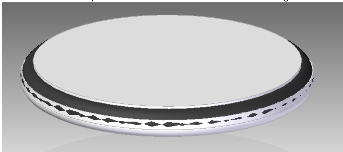
Ilustración 4. Disco que contiene el material fotocatalítico. SolidEdge ST 10
