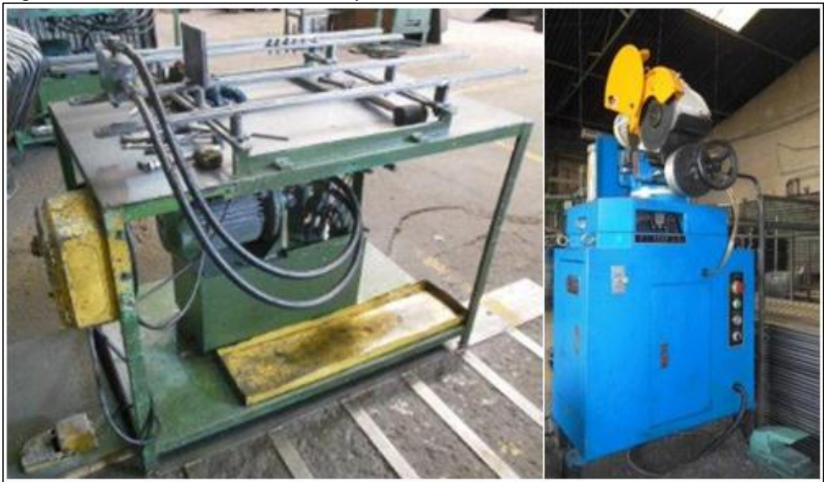
Figura 10. Punzonadora de tubería y cortadora neumática
