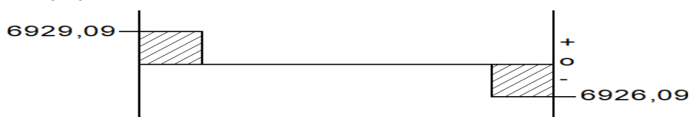
Imagen 114. Diagrama de fuerza cortante viga crítica en Y
