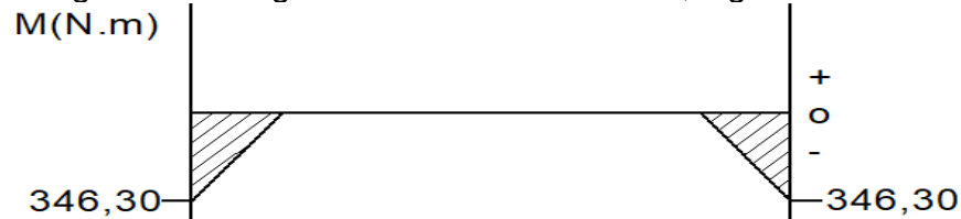
Imagen 115. Diagrama de momento flector, viga crítica en Y
