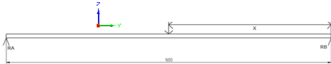
Imagen 103. Diagrama de cuerpo libre de la guía para el mecanismo en Y
