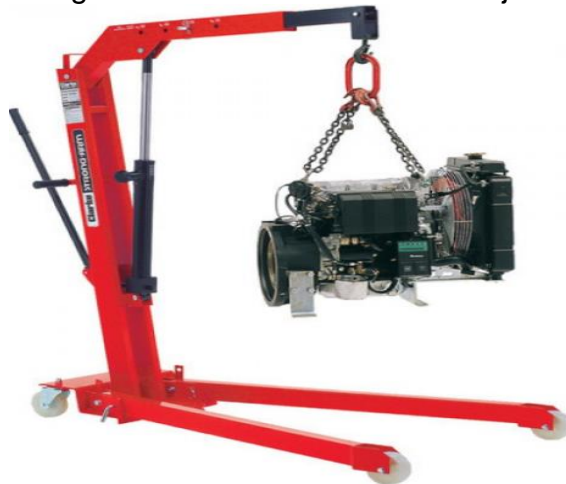
Imagen 162. Grúa con el motor sujetado
