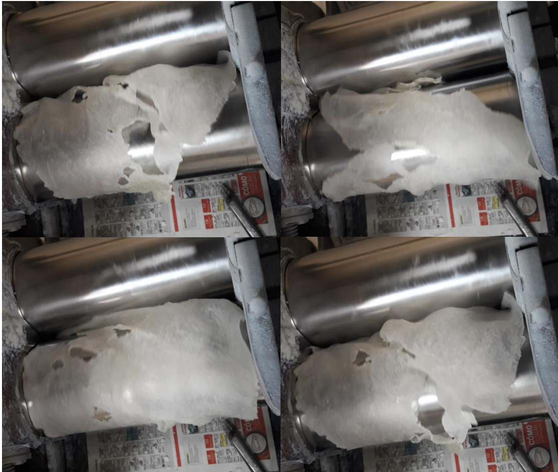
Figura 4. Homogenización en el molino de mezclas sin caucho natural.
