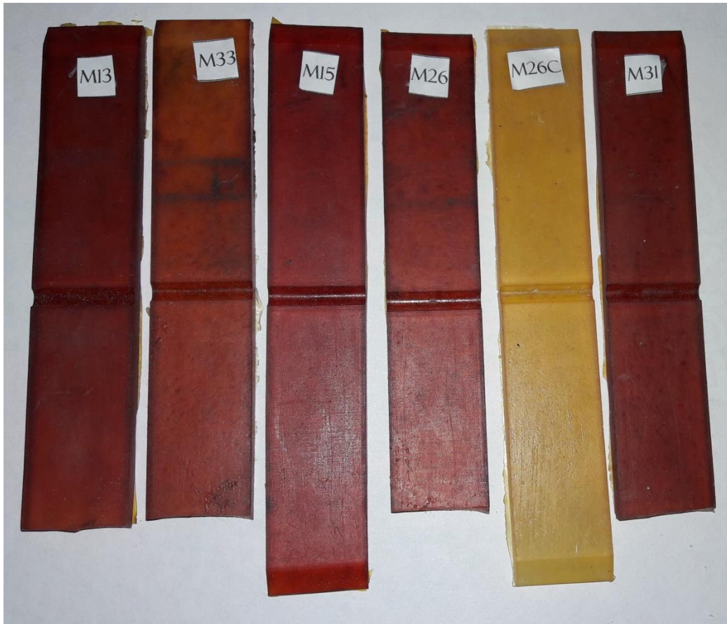
Figura 21. Muestras preseleccionadas con el primer y segundo antioxidante después de envejecimiento
