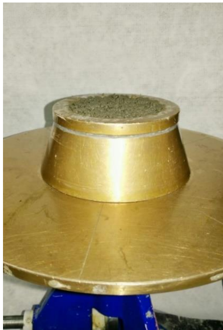
Imagen 7. Molde en mesa de flujo para cemento.
