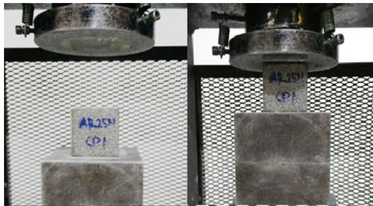
Imagen 17. Proceso de compresión en prensa hidráulica.
