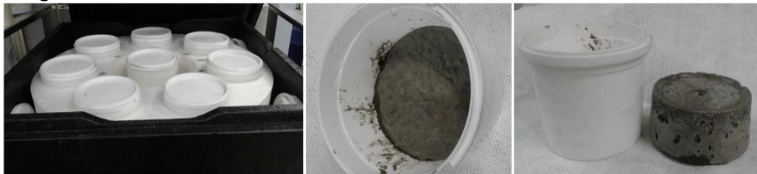
Imagen 18. Procedimiento de calorimetría en mortero.
