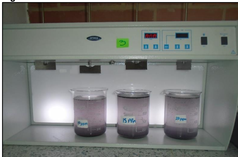
Figura 19. Test de Jarras – Prueba 3.
