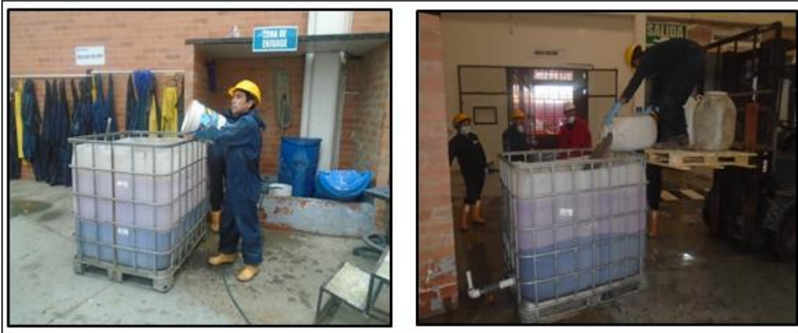
Figura 9. IBC de 1m 3 con agua residual resultante de lavados de áreas, canecas, elementos de protección personal y mezcladora.
