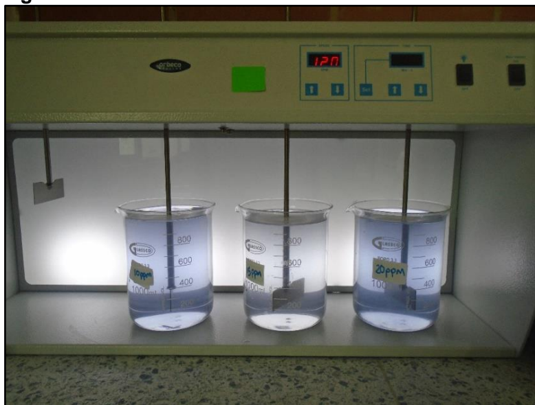
Figura 17. Test de Jarras – Prueba 1.
