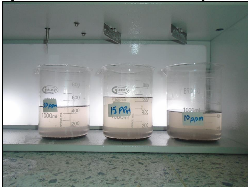
Figura 20. Eliminación del color en la muestra de agua tratada.
