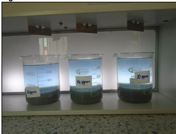
Figura 18. Test de Jarras – Prueba 2.
