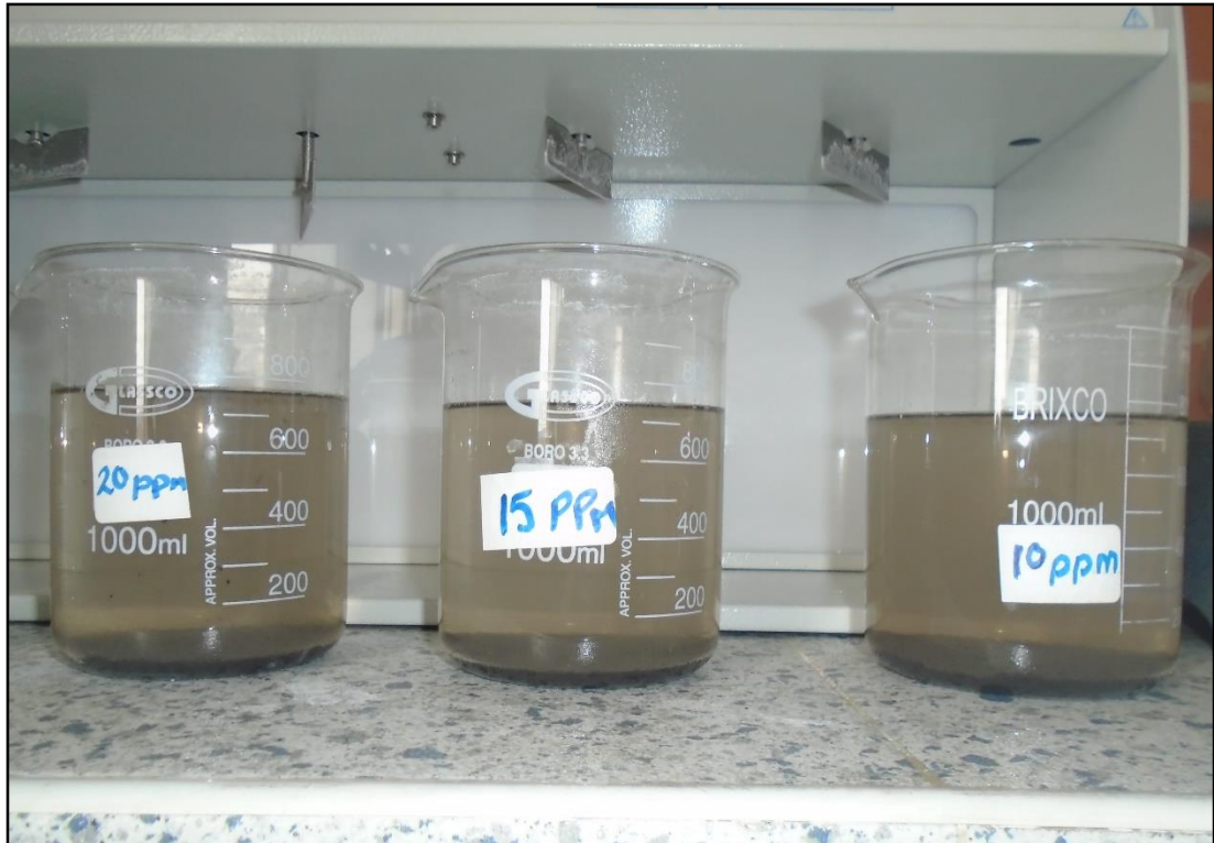
Figura 1. Primera prueba utilizando PAC 103 como coagulante y ASEFLOC 5.500 como floculante.
