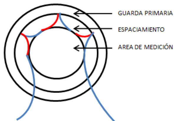
Figura 14. Ubicación de la termopila
