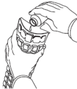
Fig 4. Adición de la mezcla de muestra y reactivo colilert al dispositivo Quanti-Tray/2000. Fuente: IDDEX Laboratories Inc. www.idexx.com/resource-library/water/colilert-procedure-en.pdf
