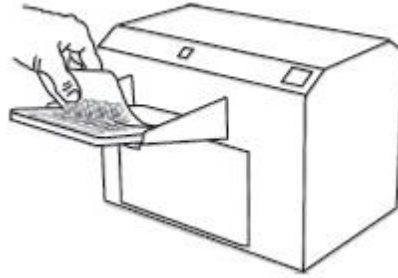
Fig 5. Sellado de la muestra. Fuente: IDDEX Laboratories Inc. Inserto kit de Colilert para prueba.
