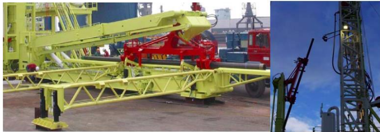
Imagen 17. Manipulador automático de tubería (Automatic pipe handler).
