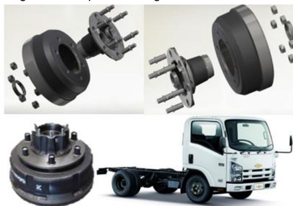
Imagen 12. Composición Diagrama estructural Cubo-Campana NKR 3.0L
