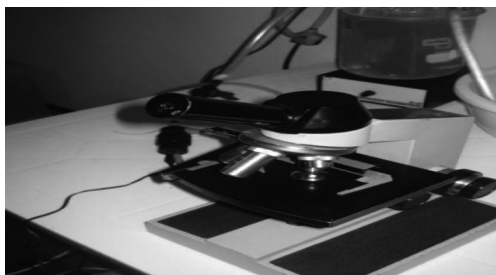
Figura 2c. Microscopio óptico usado en el conteo de microorganismo sobre cámara de Neubauer.
