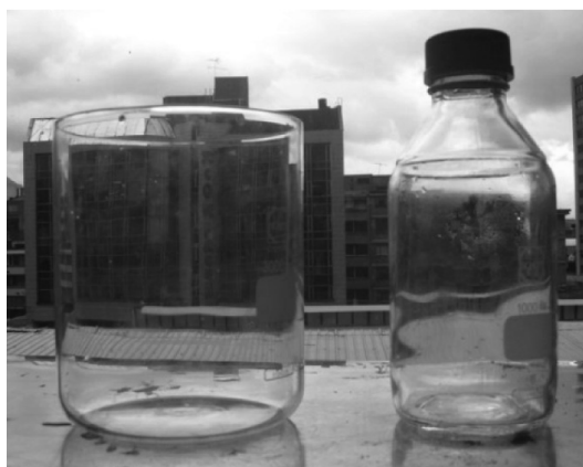
Figura 3a. Chaqueta y tanque del biorreactor.
