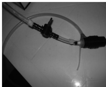
Figura 6b. Bomba usada para el descargue de la biomasa del reactor.
