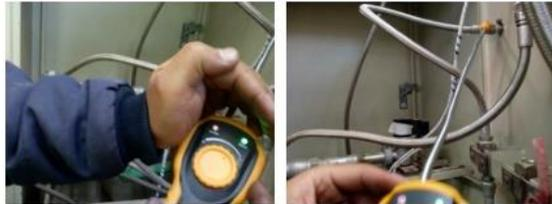
Se realiza una prueba haciendo el ciclo completo de ingreso de amoníaco hasta la cuba, con el detector de gas de amoníaco se hacen mediciones alrededor del horno y no se detecta fugas.
