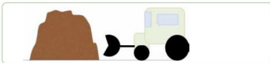
Imagen 3. Sistema de pila con volteo mecanizado.
