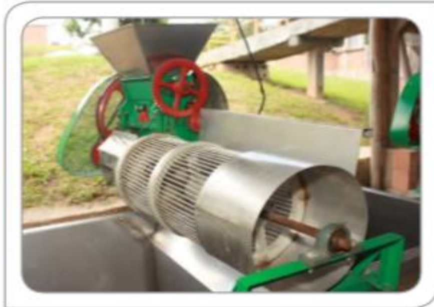
Imagen 9. Despulpadora de eje horizontal con zaranda rotatoria cilíndrica con varillas.
