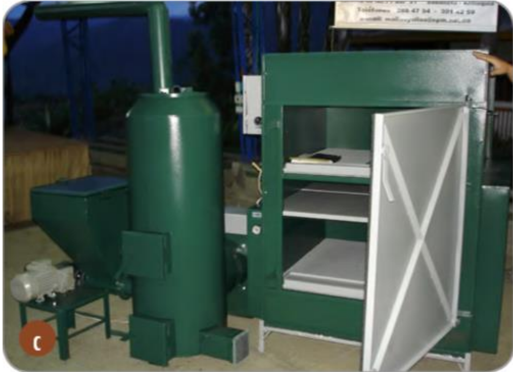
Imagen 12. Horno con intercambiador de calor y alimentación por gravedad de cascarilla de café.
